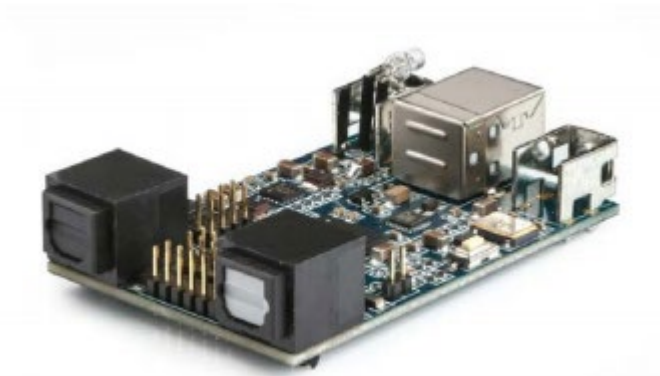
Εικόνα 6.7 USB Streamer χωρίς κουτί υποστηρίζει πρωτόκολλα TOSLINK, ADAT και I2S.[22]
