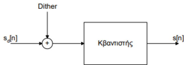
Εικόνα (3.5) Πρόσθεση θορύβου dither πριν την κβάντιση. [4]
