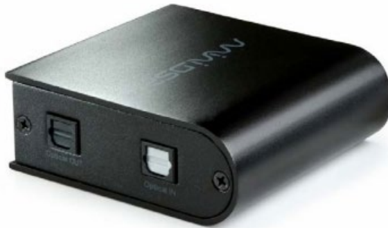
Εικόνα 6.6 USB Streamer σε κουτί υποστηρίζει πρωτόκολλα TOSLINK και ADAT.[22]
