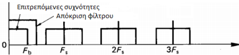
Εικόνα 2.2: Εικόνα Ιδανικού φίλτρου όπου F_b επιτρεπόμενες συχνότητες και F_s συχνοτικά είδωλα. [3]
