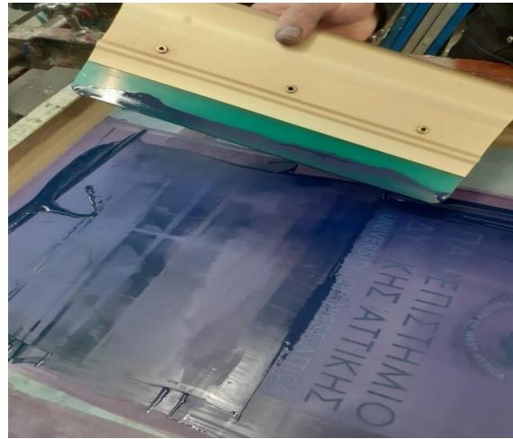
Εικόνα 35. Επάλειψη τελάρου με μελάνι.
