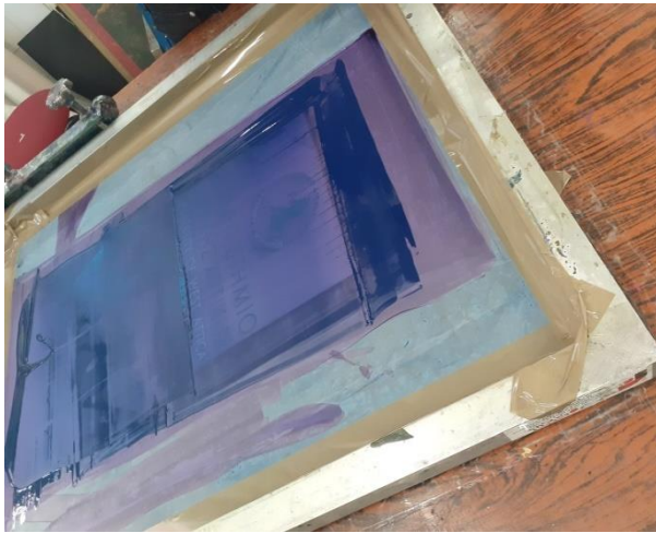
Εικόνα 35. Επάλειψη τελάρου με μελάνι.
