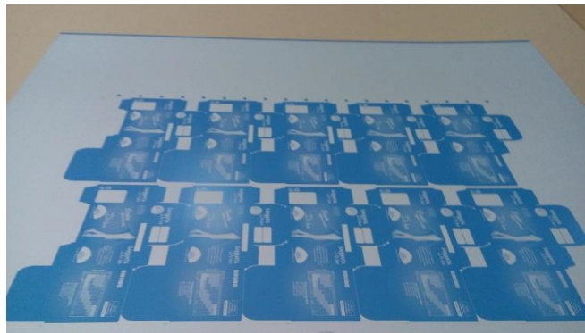
Εικόνα 6. Πλάκα εκτύπωσης αλουμινίου για την Offset.
