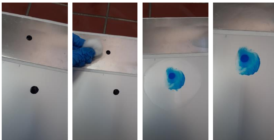
Εικόνα 19. Έλεγχος απορροφητικότητας ανοδιωμένου υποστρώματος.
