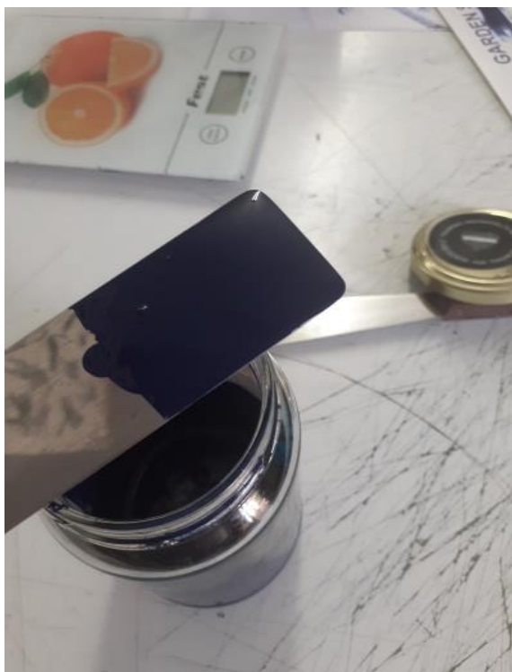
Εικόνα 31. Παρασκευή πολυουρεθανικού μελανιού PANTONE 654 C.
