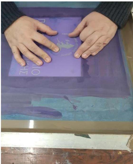
Εικόνα 34. Εύρεση συμπτώσεων και γώνιασμα.
