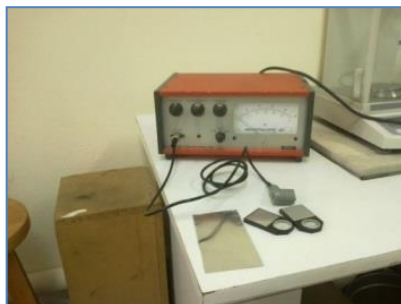
Εικόνα 18. Ανοδική Οξείδωση: διαδικασία, όργανα και δοκίμια αλουμινίου.
