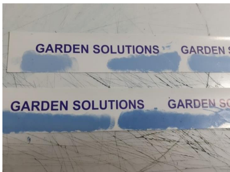
Εικόνα 30. Αποτύπωση εποξικού μελανιού PANTONE X2.
