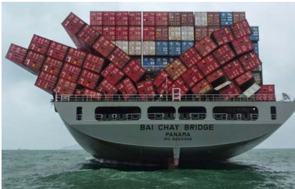
Εικόνα 24 – Απεικόνιση επίπτωσης παραμετρικού διατοιχισμού σε πλοίο container ship. 7
