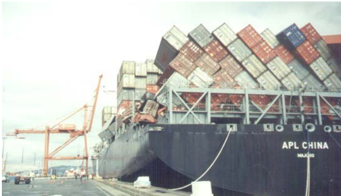
Εικόνα 53 – Αποτέλεσμα παραμετρικού διατοιχισμού σε πλοίο μεταφοράς εμπορευματοκιβωτίων (APL China). 11
