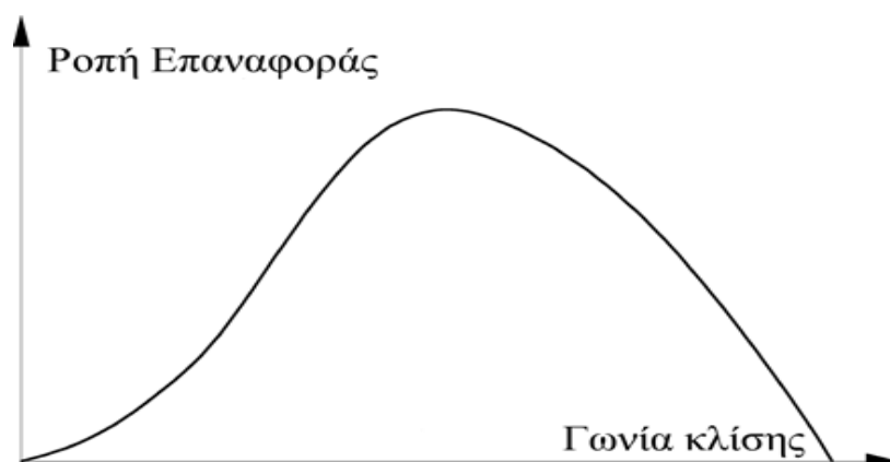
Εικόνα 3 – Απεικόνιση καμπύλης ροπής επαναφοράς. (Σπύρου, ΔΥΝΑΜΙΚΗ ΕΥΣΤΑΘΕΙΑ ΠΛΟΙΟΥ, 2006)
