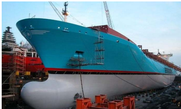
Εικόνα 48 – Απεικόνιση γάστρας πλοίου Container ship με έντονη κλίση βολβού - πλώρης (Bow flare). 10
