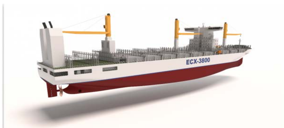
Εικόνα 23 – Πλοίο feeder ECX -3800 container ship με καλύμματα Hatchcoverless. 18
