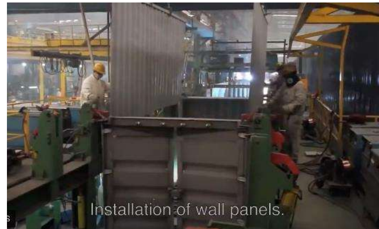
Εικ. 8 «Συγκόλληση πλαισίων πλευρών.» Πηγή: https://www.youtube.com/watch?v=z7l6AQN1KV0
