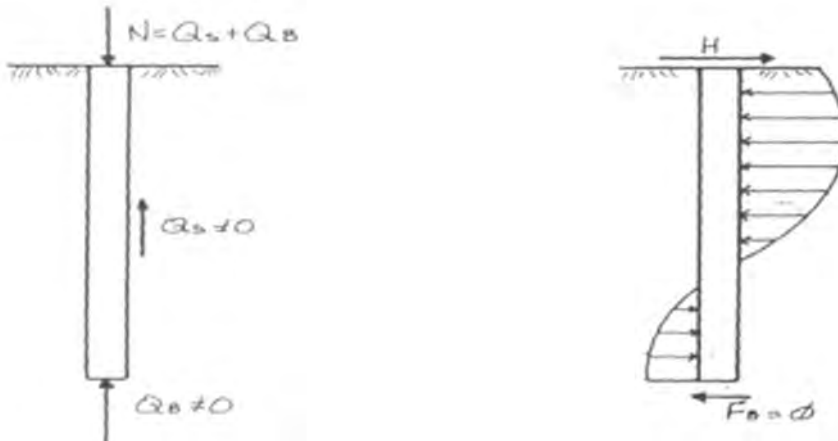
Εικόνα 1.6: Τρόπος μεταβίβασης των φορτίων στο έδαφος μίας βαθιάς θεμελίωσης. (Αναγνωστόπουλος 1994)
