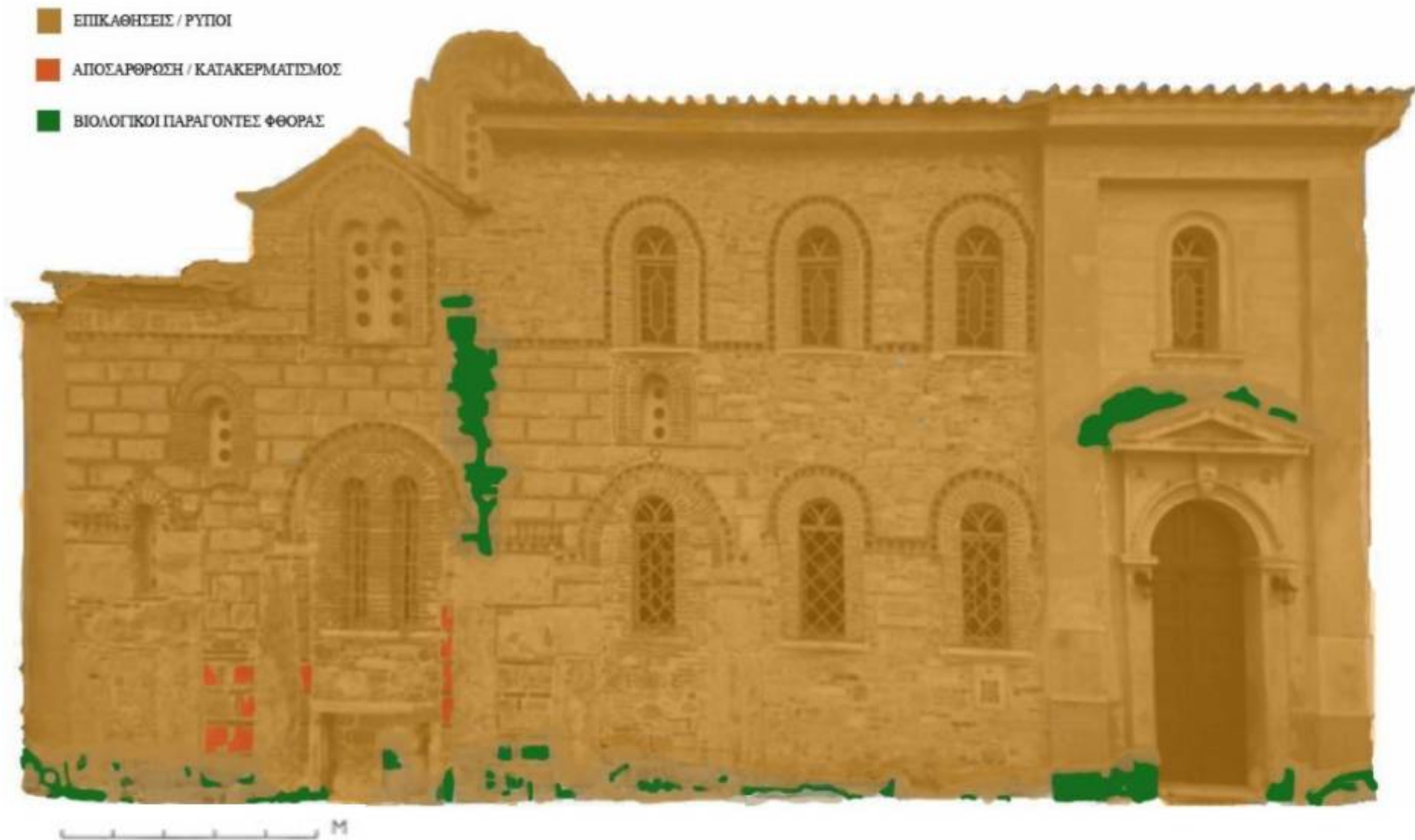
Σχήμα 3.3.15: Χαρτογράφηση της παθολογίας των δομικών υλικών του Ι.Ν. Αγίου Νικολάου Ραγκαβά
