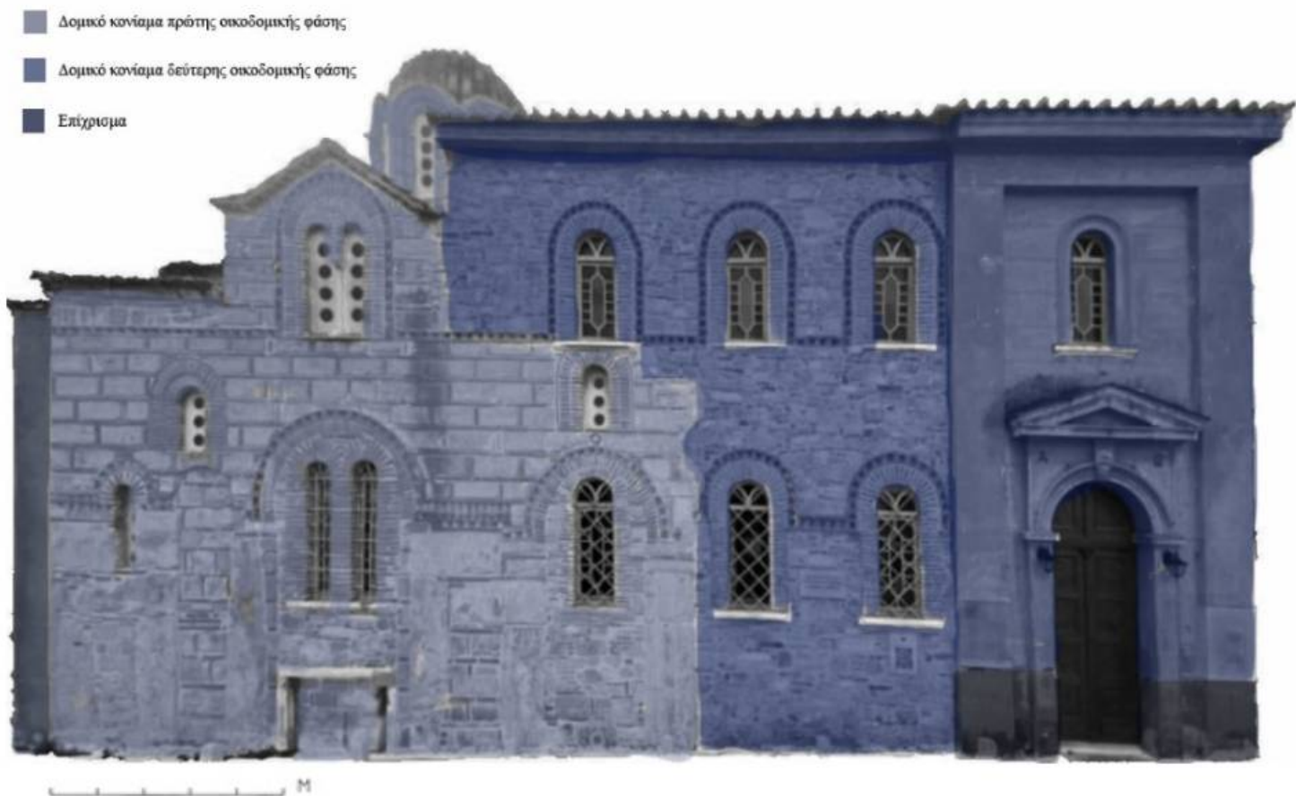
Σχήμα 2.2.11: Χαρτογράφηση κονιαμάτων στην Βόρεια πλευρά του Ι.Ν. Αγίου Νικολάου Ραγκαβά
