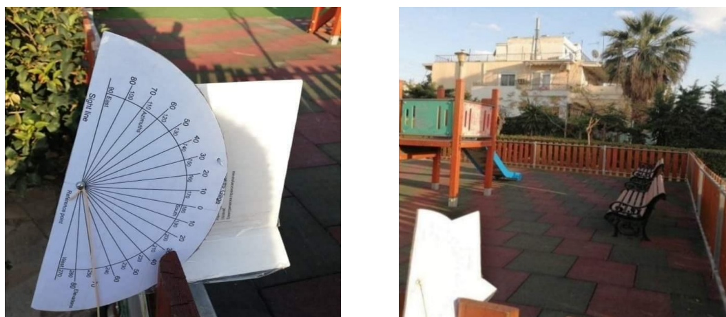
Σχήμα 1.9 : Μέτρηση σκίασης προκαλούμενης από φοίνικα με χρήση ημικυκλίου.
