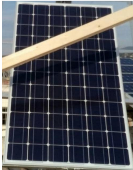
Σχήμα 3.38 : Σκιασμένο φ/β πλαίσιο οριζόντια με την χρήση μιας ξύλινης ράβδου. (Μπαμπούκης & Τσούκας, 2015).
