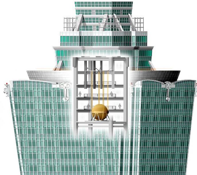
Εικόνα 3.8 Συντονισμένη μάζα απόσβεσης στο Ταϊπέι 101
