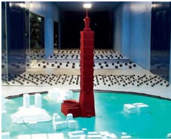
Εικόνα 4.8 Δοκιμή αεροσήραγγας στο Ταϊpei 101 (κλίμακα 1:500)
