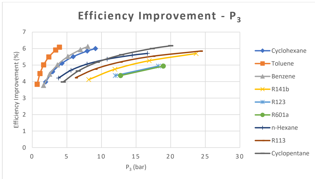
Διάγραμμα 4.4 Ποσοστό βελτίωσης του συνολικού βαθμού απόδοσης του συστήματος ORC – Diesel, για κάθε οργανικό ρευστό συναρτήσει της μέγιστης πίεσης P_3
