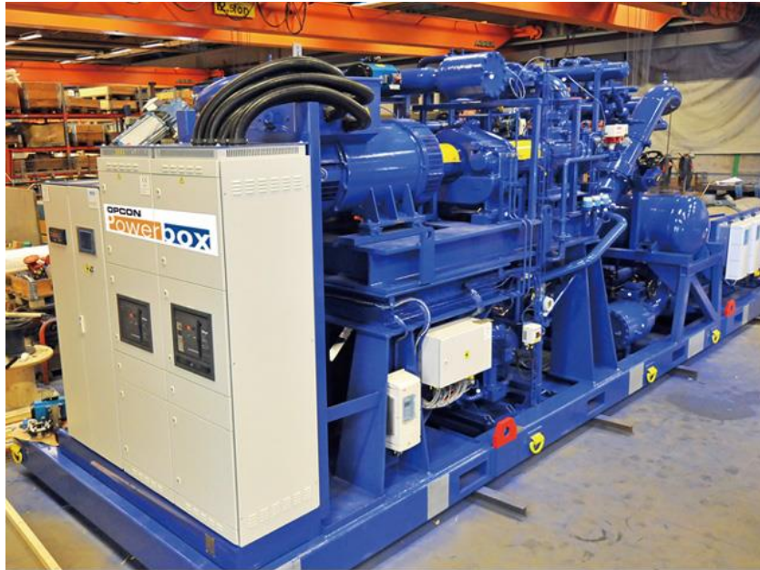
Εικόνα 3.3 Opcon Powerbox ORC (Fujian Opcon Energy Technology Co., Ltd.)
