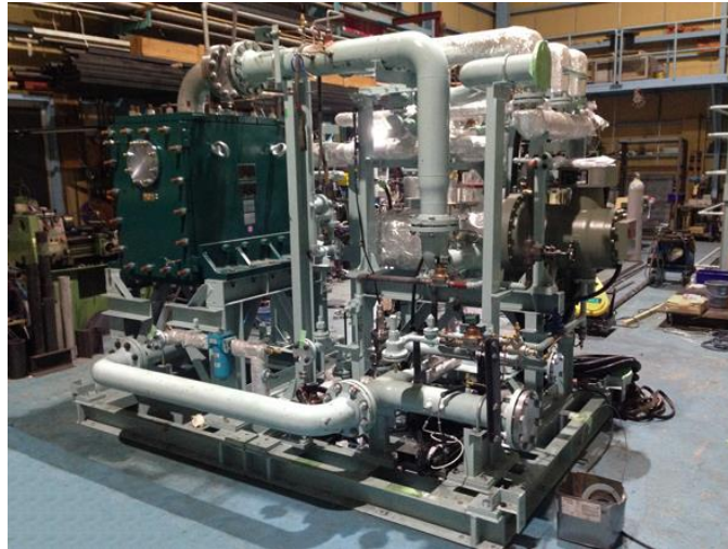
Εικόνα 3.10 Γεννήτριες παραγωγής ηλεκτρικής ενέργειας διπλού κύκλου (KOBE STEEL, LTD)
