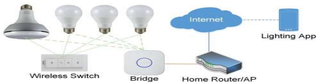
Εικόνα 9: Παράδειγμα έξυπνου συστήματος εσωτερικού φωτισμού [109]
