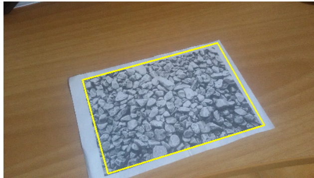
Εικόνα 3.6: Με χρήση της ομογραφίας, βρέθηκαν οι γωνίες του αντικειμένου και ενώθηκαν με κίτρινες γραμμές.
