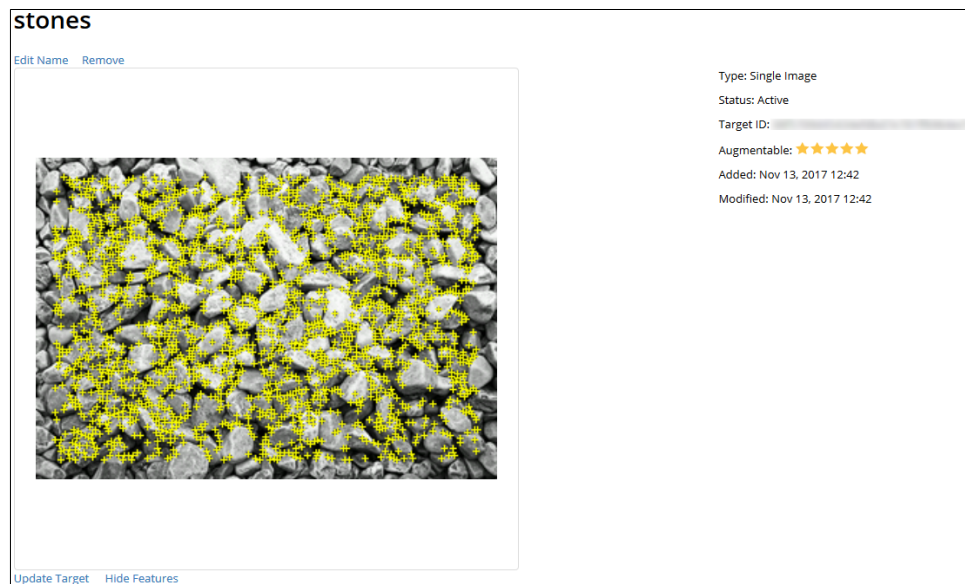
Εικόνα 2.1: Δείγμα από τη πλατφόρμα της Vuforia. Φαίνονται τα keypoints ως κίτρινοι σταυροί και η ευκολία ανίχνευσης (ένδειξη “Augmentable”) μιας εικόνας.
