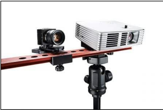
Εικόνα 2.2 DAVID Structured Light Scanner SIS-2 (2)
