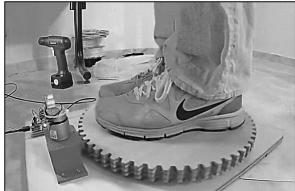
Εικόνα 2.7 Χειροποίητο turntable για μεγάλα αντικείμενα
