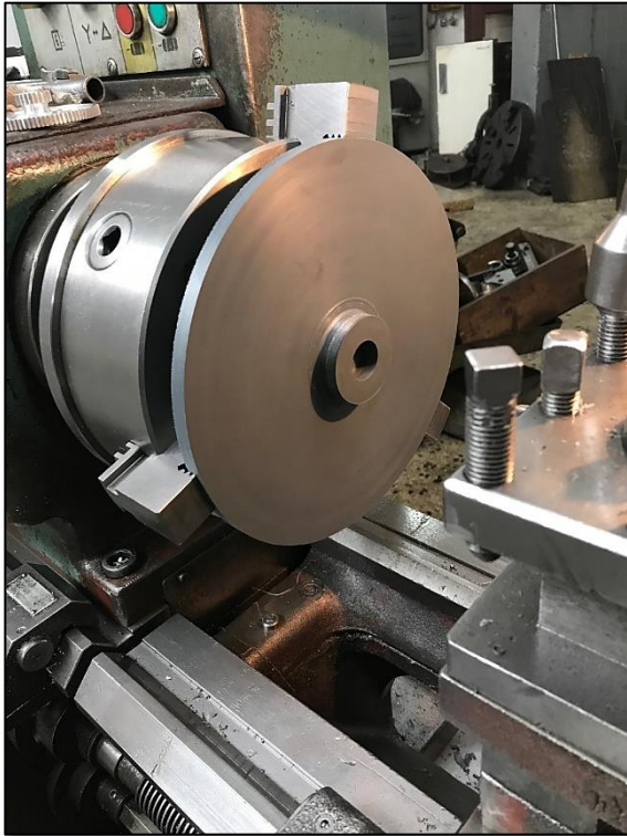
Εικόνα 7.20 Κατασκευή του καπακιού στο μηχάνημα του τόρνου (1)
