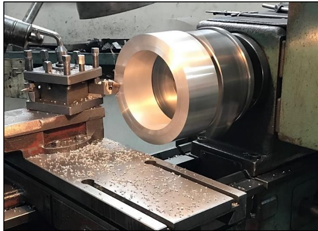
Εικόνα 7.17 Κατασκευή του κύριου κελύφους της κατασκευής στο μηχάνημα του τόρνου
