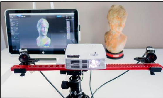
Εικόνα 2.4 DAVID Structured Light Scanner SIS-2 με χρήση turntable (2)
