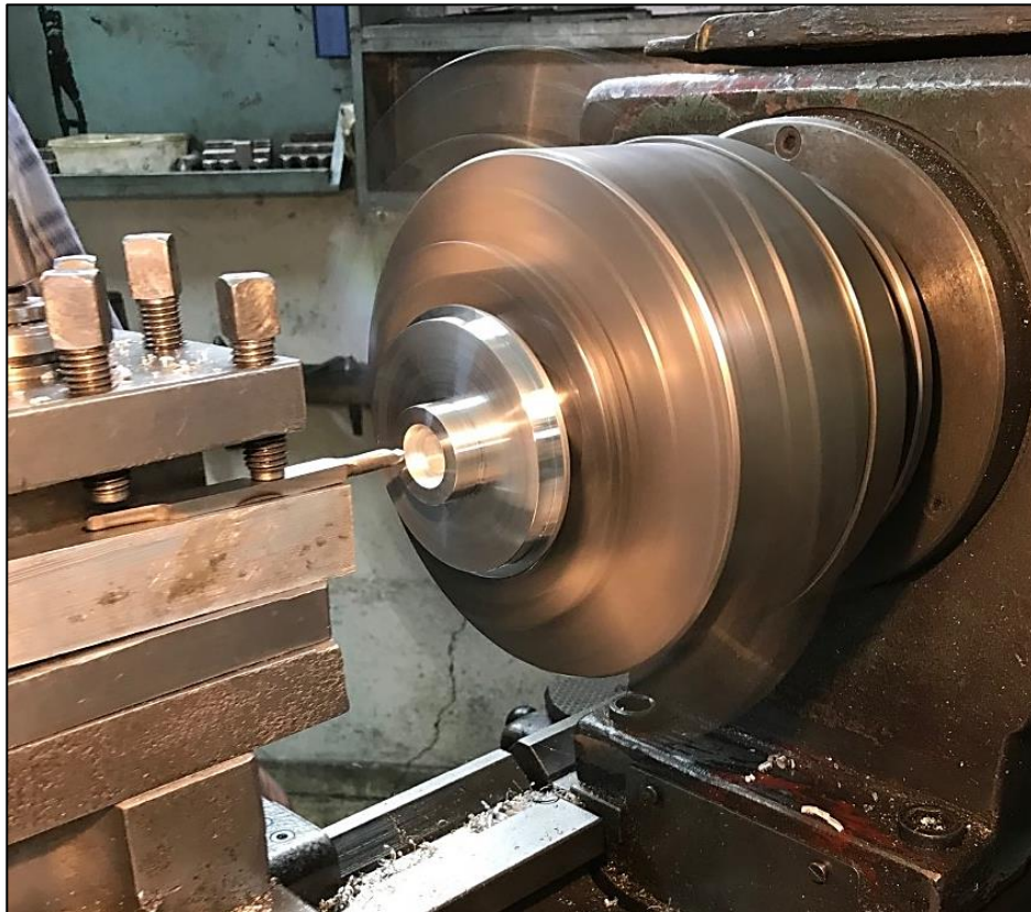
Εικόνα 7.15 Κατασκευή των γραναζιών στο μηχάνημα του τόρνου (2)
