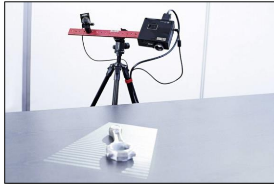
Εικόνα 2.1 DAVID Structured Light Scanner SIS-2 (1)
