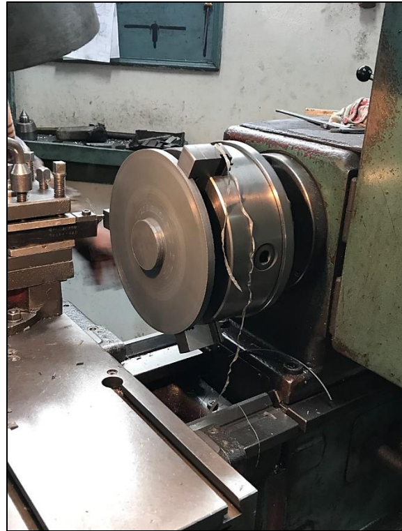
Εικόνα 7.19 Κατασκευή του καπακιού στο μηχάνημα του τόρνου (2)
