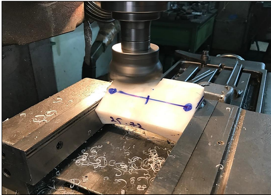
Εικόνα 7.23 Κατασκευή της βάση για την οθόνη και την πλακέτα στο μηχάνημα της φρέζας
