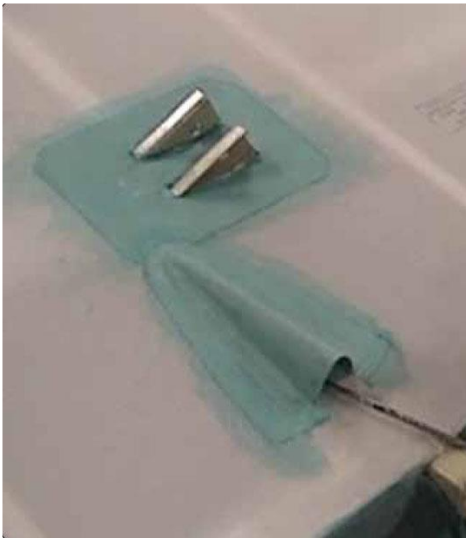
Σχήμα 2.6.2.3. Ένας σύνδεσμος με γόνατο και οδηγός καλωδίων με ενισχυμένα υφάσματα στη θέση τους.
