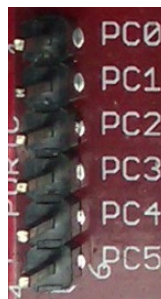
Εικόνα 4.6.1 Ακροδέκτες που συνδέονται στην πόρτα C ενός μικροελεγκτή ATmega8
