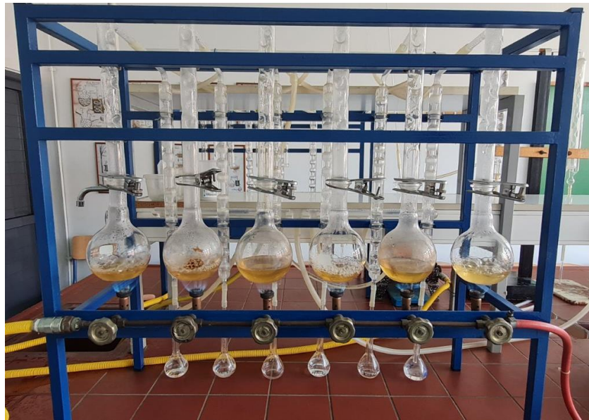
Εικόνα 4.9 Απόσταξη υδρόμελων σε αποστακτική στήλη
