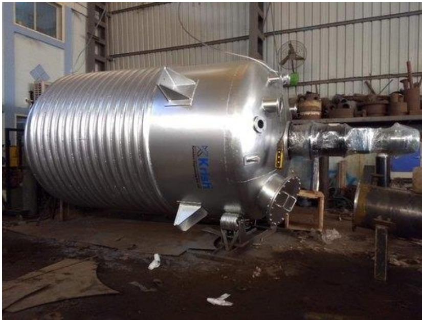
Εικόνα 3 Δοχείο υψηλής πίεσης από ανοξείδωτο χάλυβα [4]
