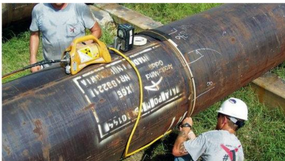
Εικόνα 19 Ραδιογραφία σε κυλινδρικό αγωγό [26]
