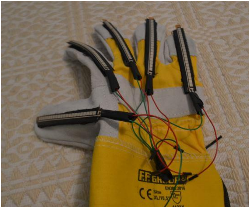
Εικόνα 3-16. Τοποθέτηση αισθητήρων κάμψης με τα καλώδια.
