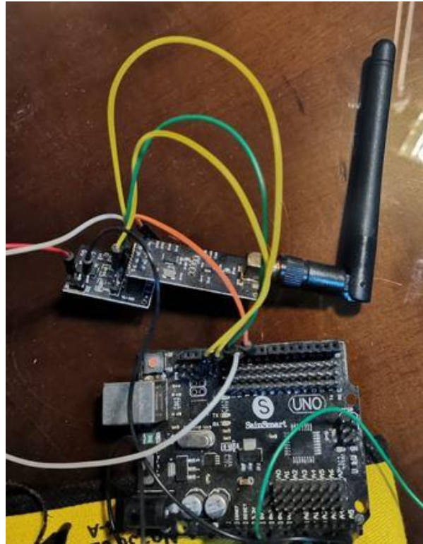
Εικόνα 3-18. Σύνδεση Arduino Uno με το nRF24L01.
