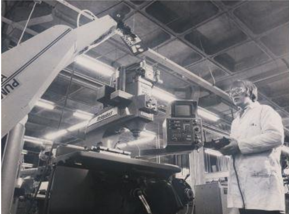
Εικόνα 1-7. Βιομηχανικό ρομπότ Puma 500, ελεγχόμενο από υπολογιστή(Πηγή:[7] ).
