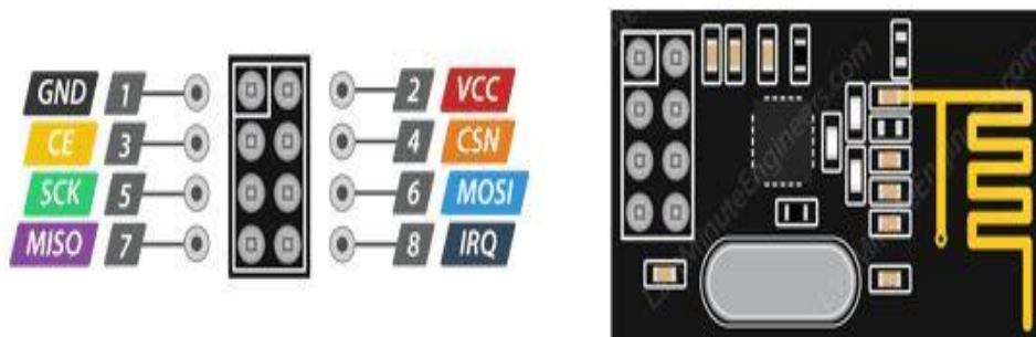
Εικόνα 2-8. Ακροδέκτες nRF24L01(Πηγή:[8] ).
