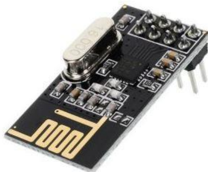
Εικόνα 2-4. nRF24L01 χωρίς κεραία(Πηγή:[8] ).
