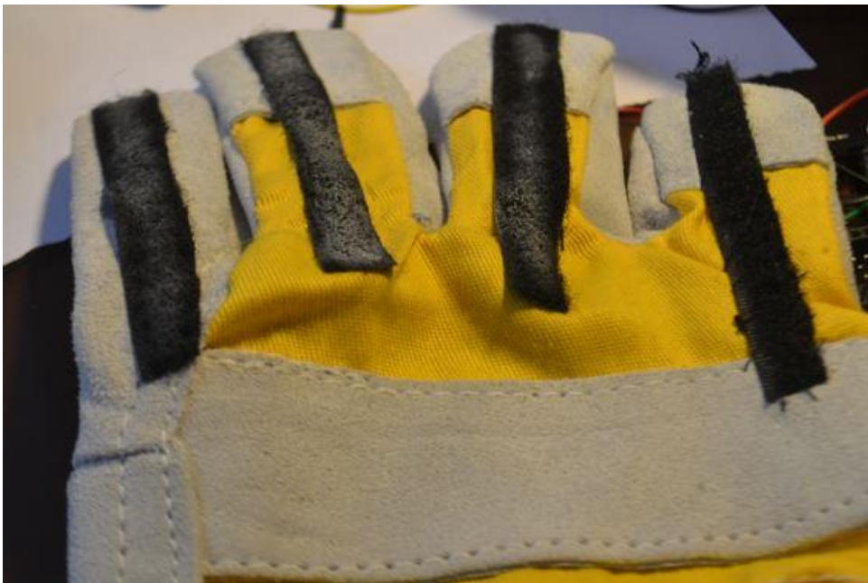
Εικόνα 3-15. Τοποθέτηση αυτοκόλλητων ταινιών στο γάντι.
