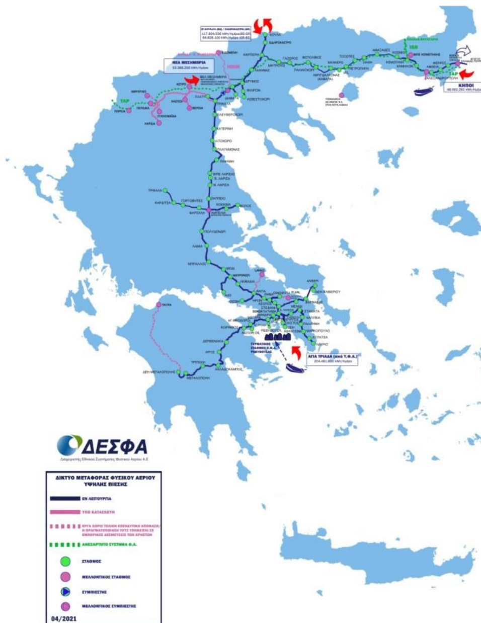
Εικόνα 3.1. Ο τερματικός σταθμός της Ρεβυθούσας και το εθνικό σύστημα μεταφοράς φυσικού αερίου,
