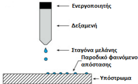
Εικόνα 3.22: Material Jetting με τεχνολογία DOD
