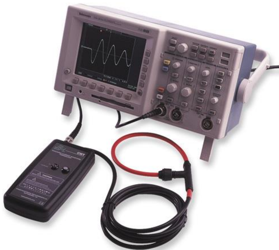
Εικόνα 5-11 Πηνίο Rogowski συνδεδεμένο σε παλμογράφο [33] © http://www.pemuk.com/products/cwt-current-probe/cwt.aspx
