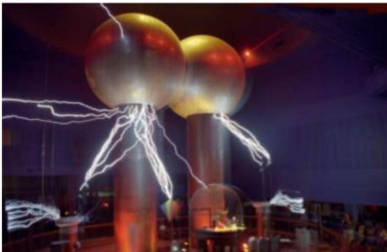
Εικόνα 3-22 Γεννήτρια Van de Graaff σε λειτουργία [26] © Σημειώσεις Εργαστηρίου Υψηλών Τάσεων, Εθνικό Μετσόβιο Πολυτεχνείο, /Βασίλειος Π. Ανδροβιτσανέας, Νικολέτα Χ. Ηλία,
