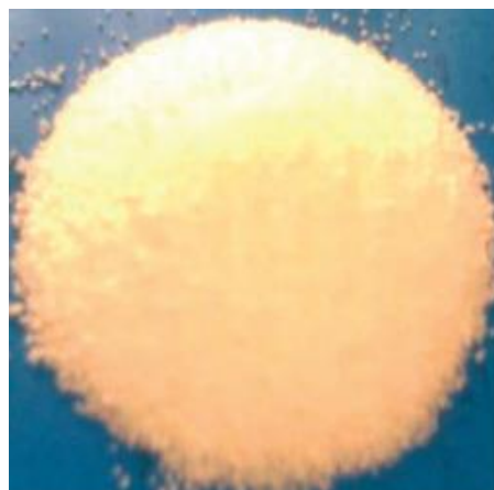
Εικόνα 3.2 : ΥΑΦ – PCM , Στεαρικό οξύ στην αρχική του κατάσταση. [15].
