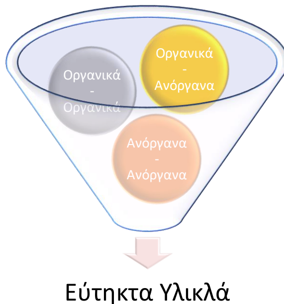
Σχήμα 3.10 : Συνδυασμοί από του οποίους μπορούν να προκύψουν εύτηκτα υλικά.
