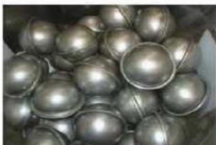
Εικόνα 4.3 : Ανοξείδωτα σφαιρίδια κάψουλας. [20]
