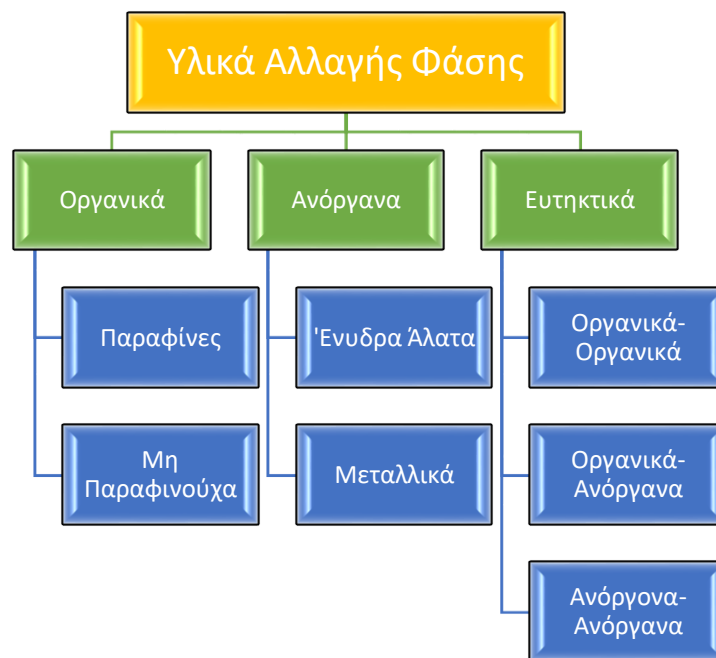
Σχήμα 3.7 : Ταξινόμηση ΥΑΦ – PCM με γνώμονα την σύστασή τους.
