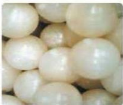
Εικόνα 4.1 : TEAP σφαιρική κάψουλα πολυολεφίνης. [20]
