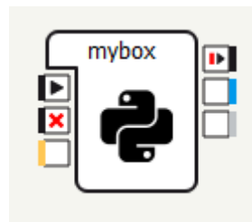
Εικόνα 25: Είσοδοι/έξοδοι κουτιού. Το μαύρο αντιστοιχεί στο bang, το κίτρινο στο number, το γαλάζιο στο string και το γκρι στο dynamic
