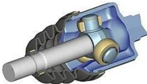
Εικόνα 5.1.1ε (Τομή από tripod joint)
