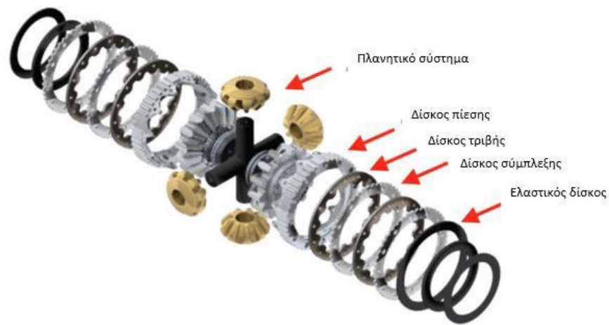
Εικόνα 4.2α ( Μέρη του διαφορικού. Από 2010 FSAE LSD (Image courtesy of Drexler))
