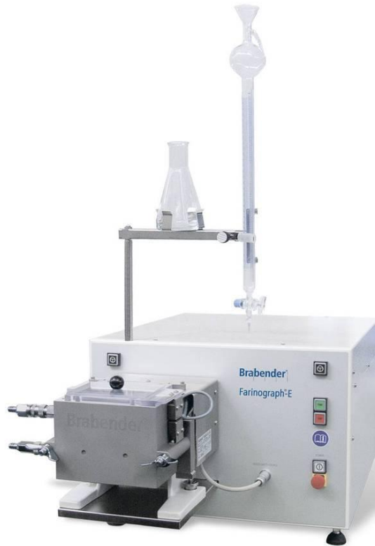
Εικόνα 16. Φαρινογράφος - Brabender Farinograph E ( https://www.brabender.com/en/food/products/rheometers/farinograph-e/ )
