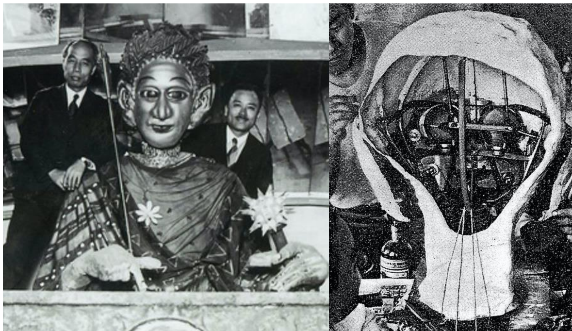
Figure 56 (Αριστερά) Από αριστερά προς τα δεξιά: ο Makoto Nishimura, το Gakutensoku και ο Bōji Nagao (βοηθός). (Δεξιά) ο εσωτερικός μηχανισμός του κεφαλιού του Gakutensoku. [364]
