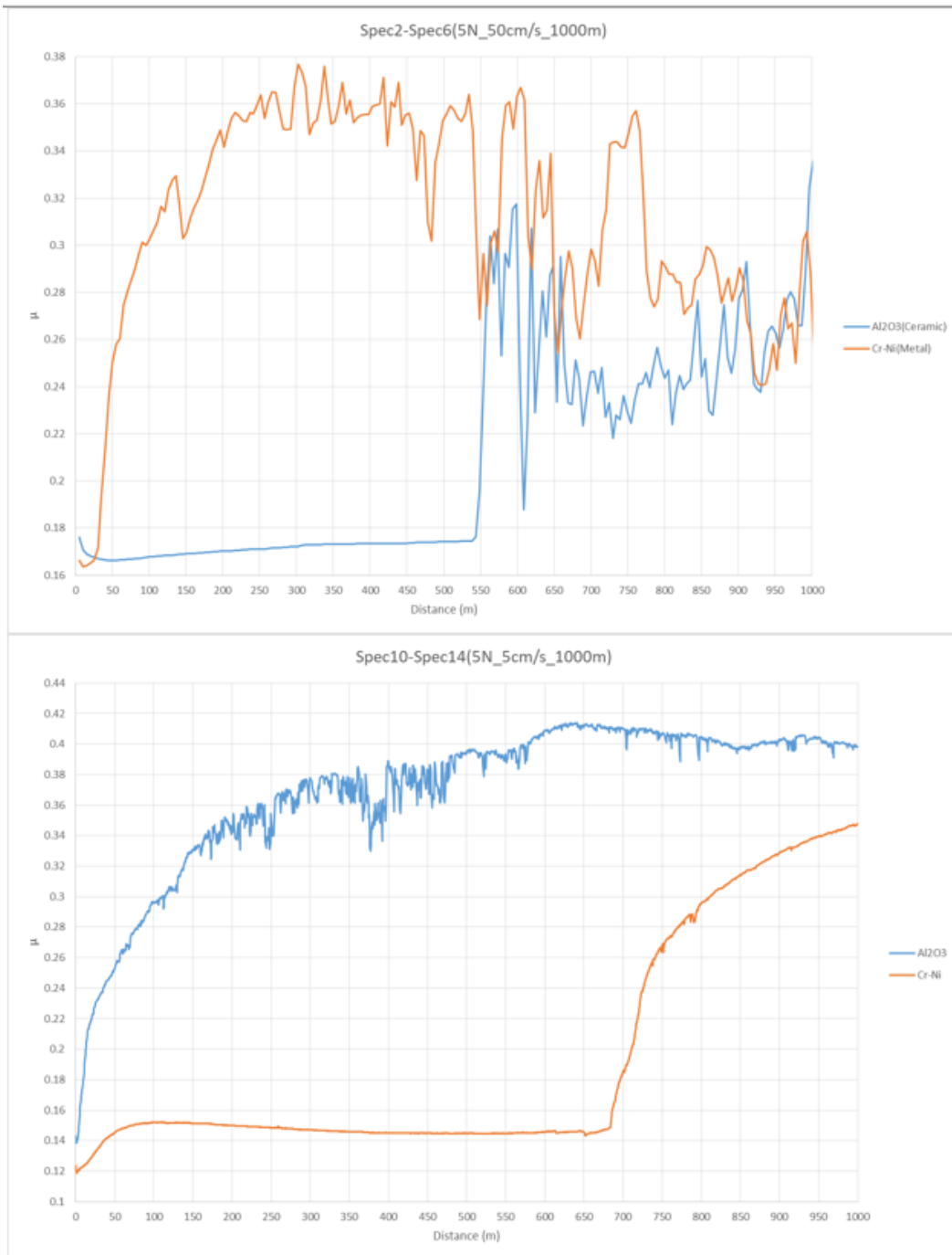
Σχήμα 25: Συντελεστής τριβής σε συνάρτηση με την απόσταση ολίσθησης για δύο ανταγωνιστικά υλικά Al 2 O 3 και Cr-Ni χάλυβα για επιβαλλόμενο κάθετο φορτίο 5N και ταχύτητα α) 50cm/s, β) 5cm/s.
