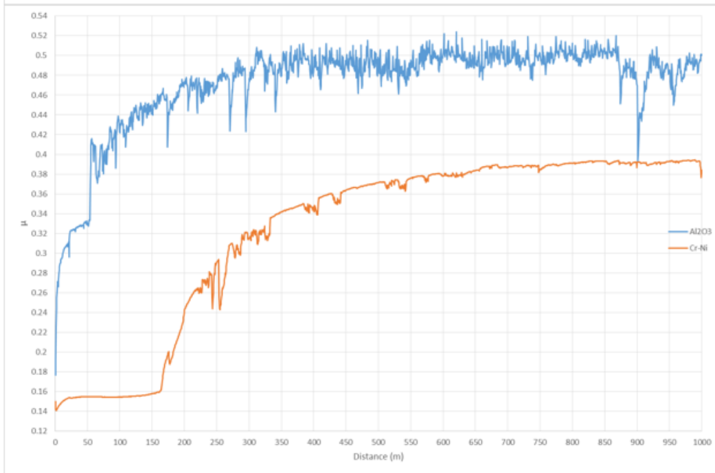
Σχήμα 24: Συντελεστής τριβής σε συνάρτηση με την απόσταση ολίσθησης για δύο ανταγωνιστικά υλικά Al_2O_3 και Cr-Ni χάλυβα για επιβαλλόμενο κάθετο φορτίο 10N και ταχύτητα α) 50cm/s, β) 5cm/s.
