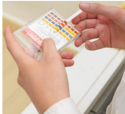
Εικόνες 123,124 Μέτρηση του pH με πεχαμετρικές ταινίες
