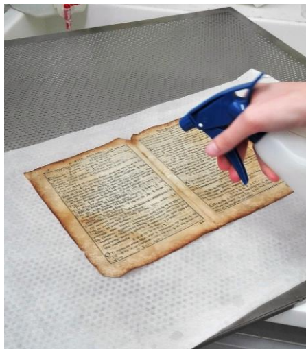
Εικόνα 114 Διαβροχή δίφυλλων με διάλυμα νερού-αιθανόλης 1:1
