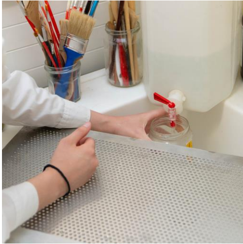
Εικόνες 121,122 Δημιουργία υδατικού διαλύματος υδροξειδίου του ασβεστίου
