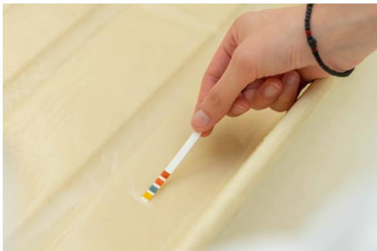
Εικόνες 123,124 Μέτρηση του pH με πεχαμετρικές ταινίες
