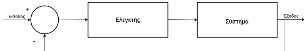
[Εικ. 17] Κλειστό σύστημα ελέγχου
