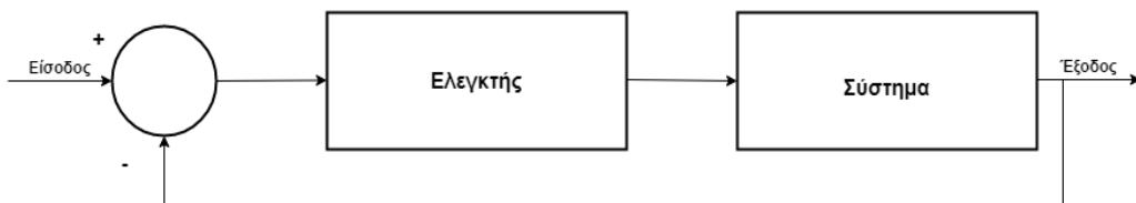
[Εικ. 16] Κλειστό σύστημα ελέγχου
