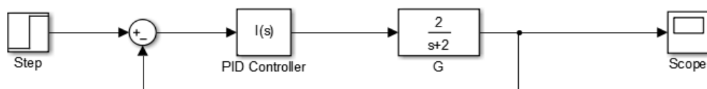
[Εικ. 77] Διάγραμμα στο SIMULINK κλειστού συστήματος με ελεγκτή I
