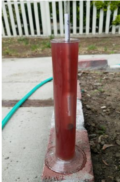
Εικόνα 15. Μέτρηση plato στη μπίρα.
