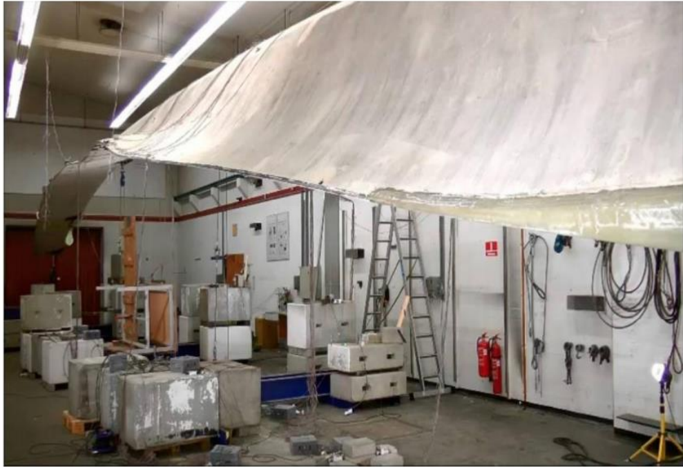
Σχήμα 3.3 Πλήρης στατικός έλεγχος πτέρυγας 32m σε εναλλασσόμενα flapwise και edgewise φορτία
