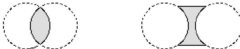
Σχήμα 1.6 Παράδειγμα κατασκευής φακών με τόξα κύκλων [4]
