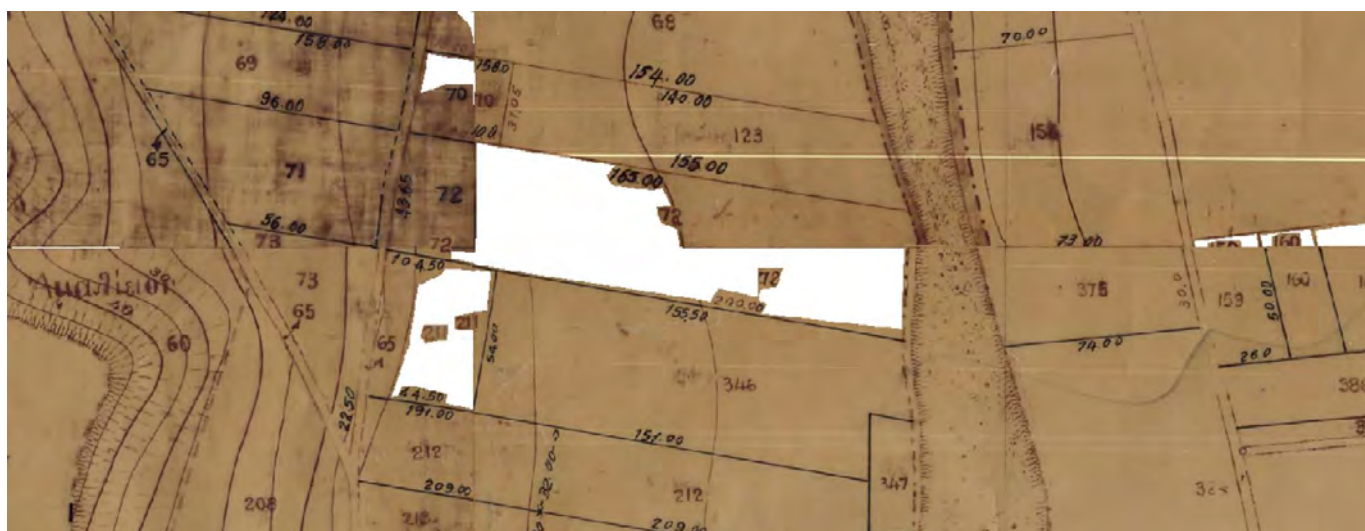
Εικόνα 26: Παράδειγμα μη ακριβούς συρραφής πινακίδων σε μεμονωμένες περιοχές στην περιοχή του Ωρωπού
