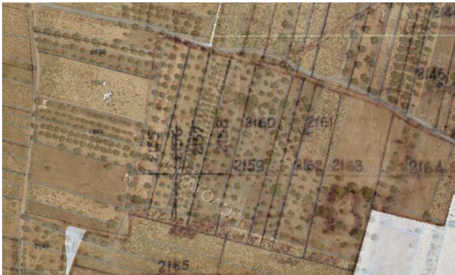
Εικόνα 66: Απόσπασμα ταύτισης μετασηματισμού χαρτών διανομής Βούρβα με τα γεωτεμάχια του κτηματολογίου σε υπόβαθρο ορθοφωτοχαρτών κτηματολογίου
