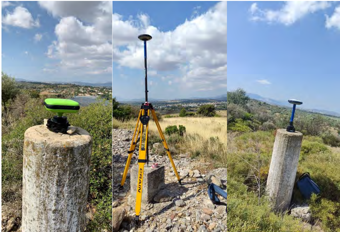
Εικόνα 34: Φωτογραφίες τριγωνομετρικών σημείων κατά την διάρκεια του τριγωνισμού
