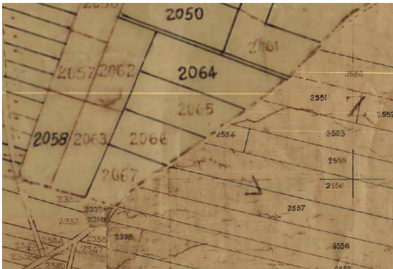
Εικόνα 25: Παράδειγμα μη ακριβούς συρραφής σε ενδιάμεσα σημεία μεταξύ διαφορετικών πινακίδων στην περιοχή του Βούρβα
