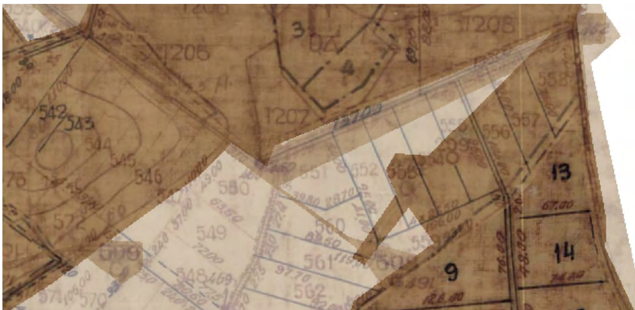
Εικόνα 28: Παράδειγμα ορθής ακρίβειας συρραφής πινακίδων διαφορετικών χρονολογικών περιόδων στην περιοχή της Ραφήνας
