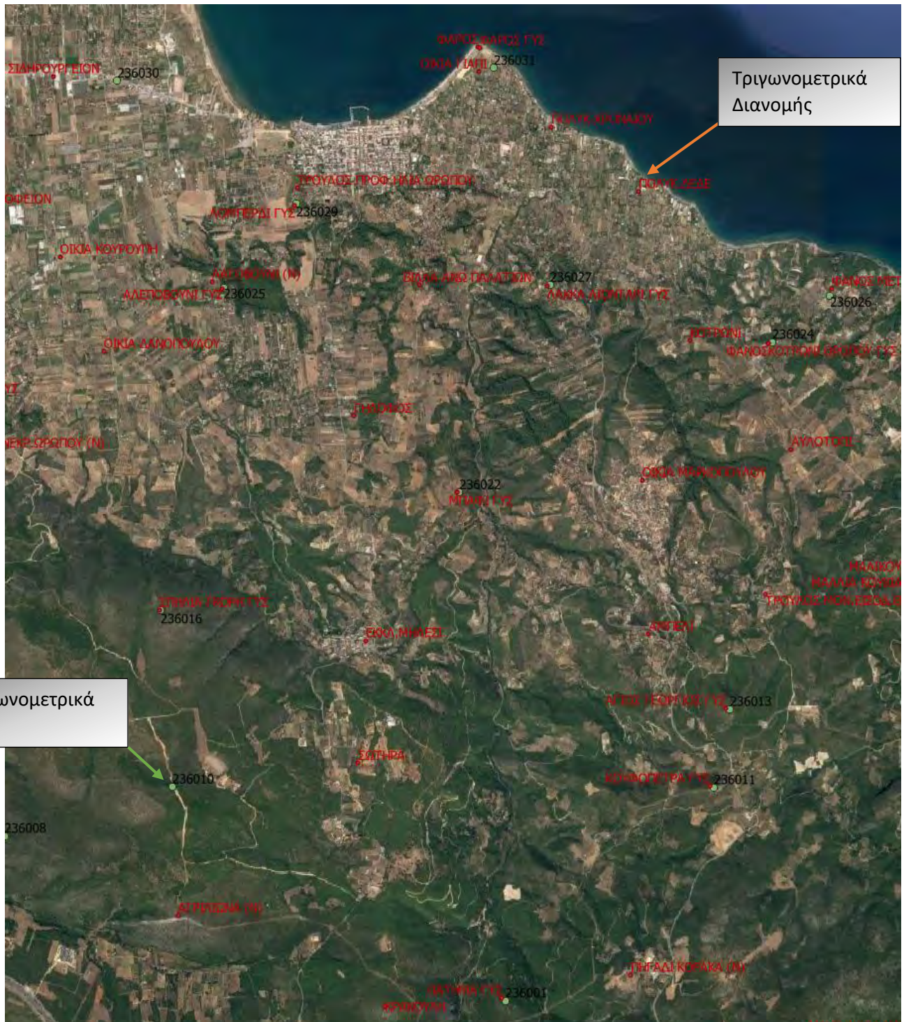
Εικόνα 30: : Θέσεις τριγωνομετρικών σημείων διανομής Ωρωπού και Γ.Υ.Σ. σε υπόβαθρο google earth στο QGIS
