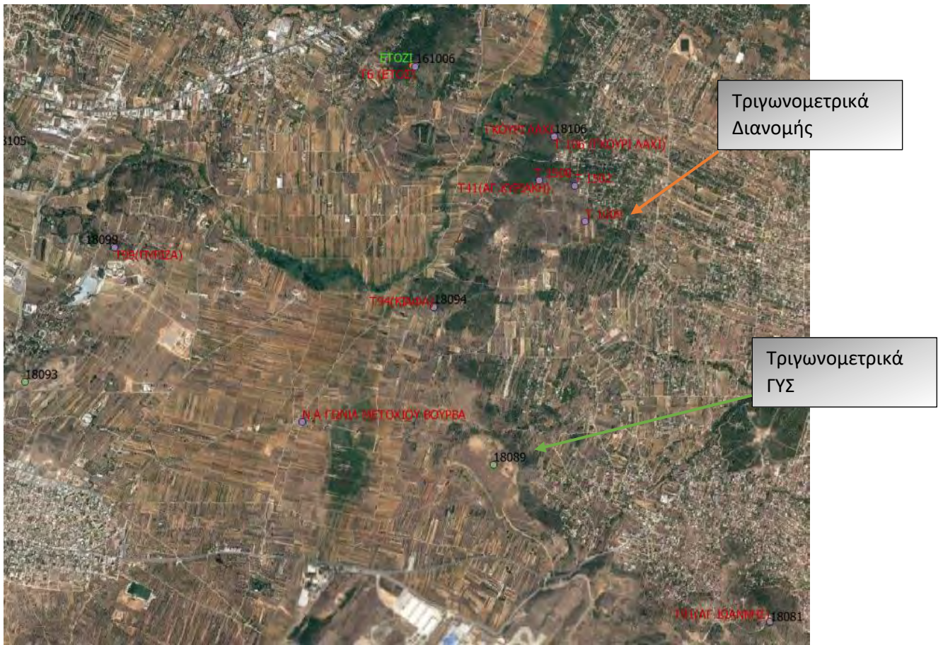
Εικόνα 31: Θέσεις τριγωνομετρικών σημείων διανομής Βούρβα και Γ.Υ.Σ. σε υπόβαθρο google earth στο QGIS
