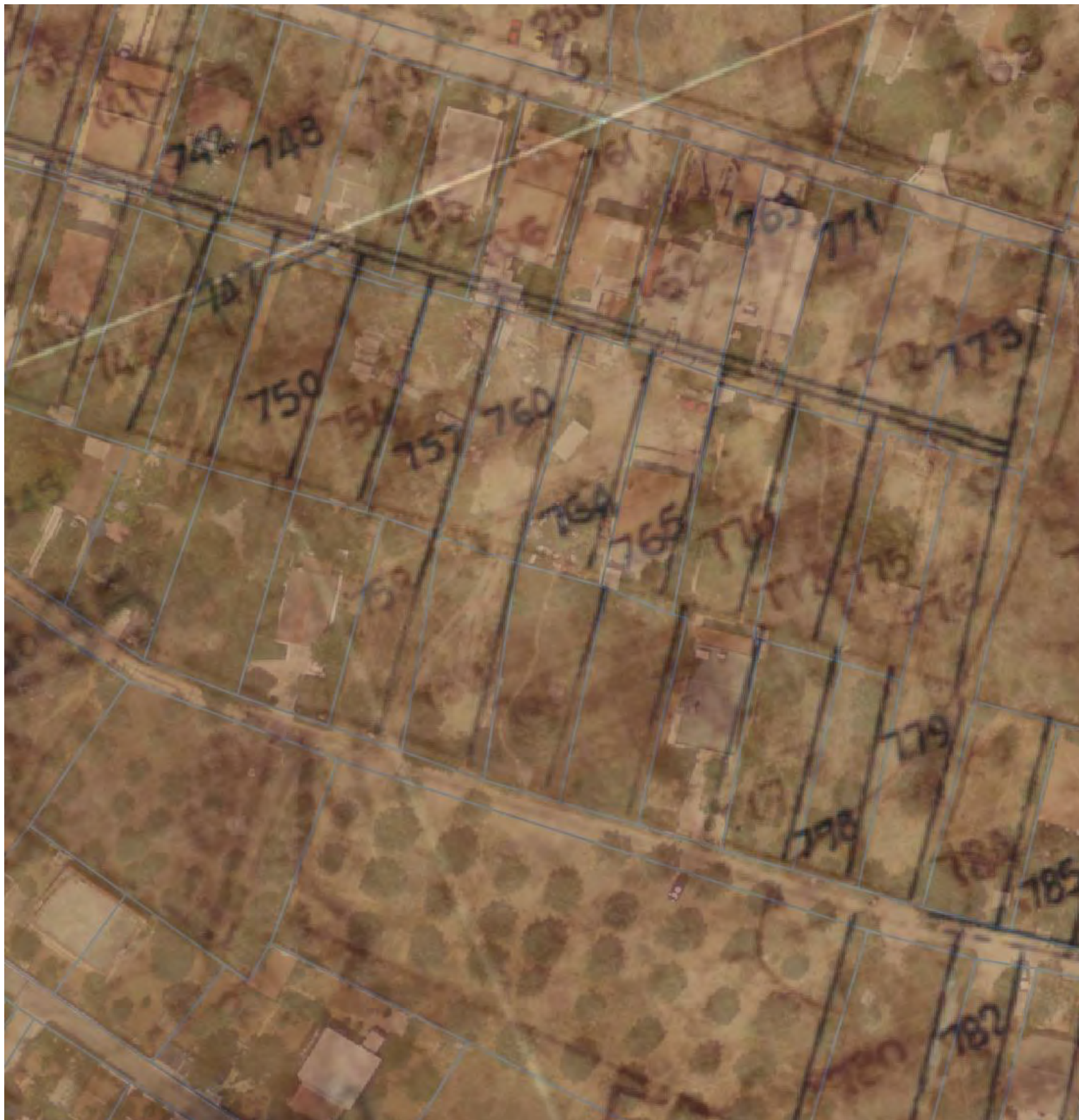
Εικόνα 77: Απόσπασμα ταύτισης μετασχηματισμού χαρτών διανομής Ραφήνας με τα γεωτεμάχια του κτηματολογίου σε υπόβαθρο ορθοφωτοχαρτών κτηματολογίου
