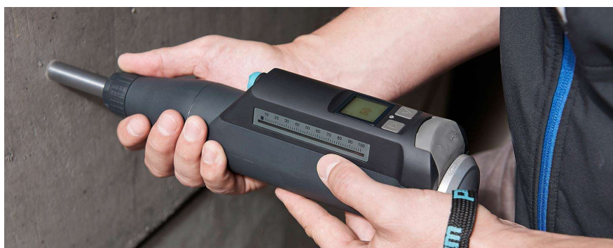
Εικόνα 3.2: Μη καταστροφική μέθοδος κρουσιμέτρησης
