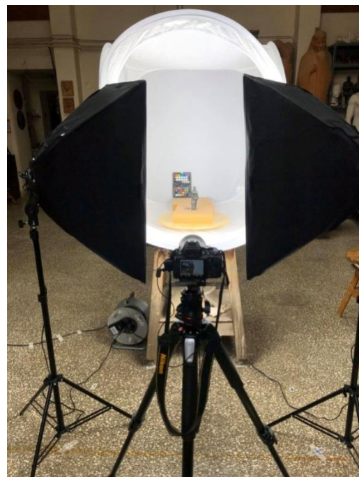
Εικ. 73 / 74: Η διάταξη λήψης των φωτογραμμετρικών δεδομένων.
