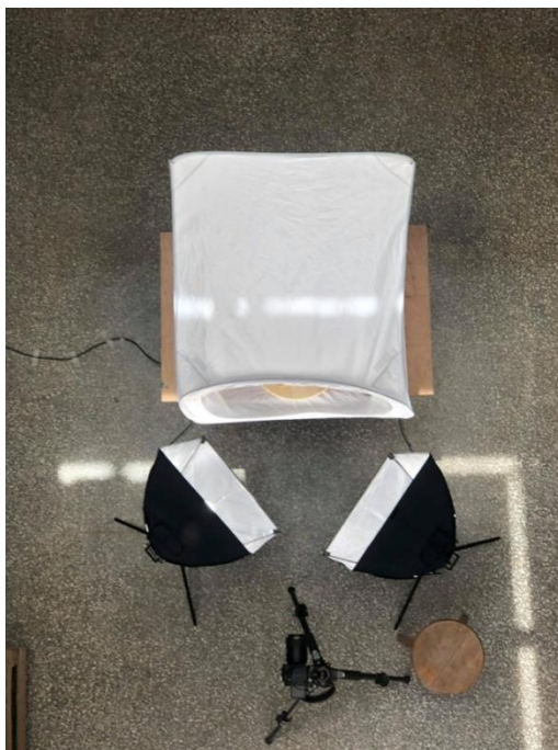
Εικ. 73 / 74: Η διάταξη λήψης των φωτογραμμετρικών δεδομένων.
