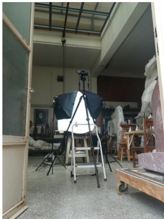
Εικ. 76: Λήψη πρωτογενών δεδομένων φωτογραμμετρίας / Η διάταξη του εξοπλισμού.
