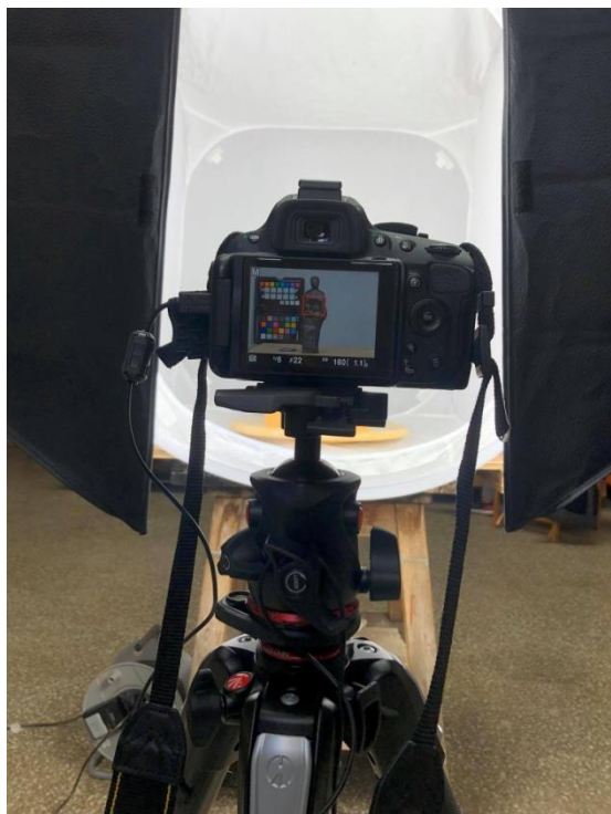
Εικ. 75: Λήψη πρωτογενών δεδομένων φωτογραμμετρίας
