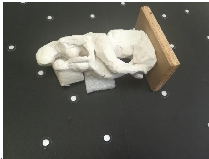
Εικ. 108: Η στήριξη του αντικειμένου με φελιζόλ
