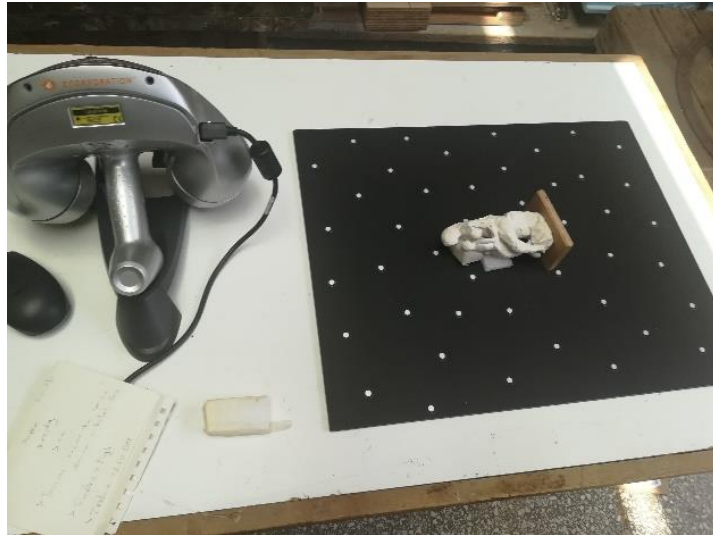
Εικ.107: Το αντικείμενο τοποθετημένο στη βάση με τους ανακλαστικούς στόχους και το φελιζόλ.
