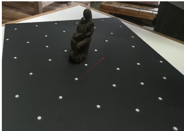
Εικ. 106: Το αντικείμενο τοποθετημένο στη βάση με τους ανακλαστικούς στόχους.
