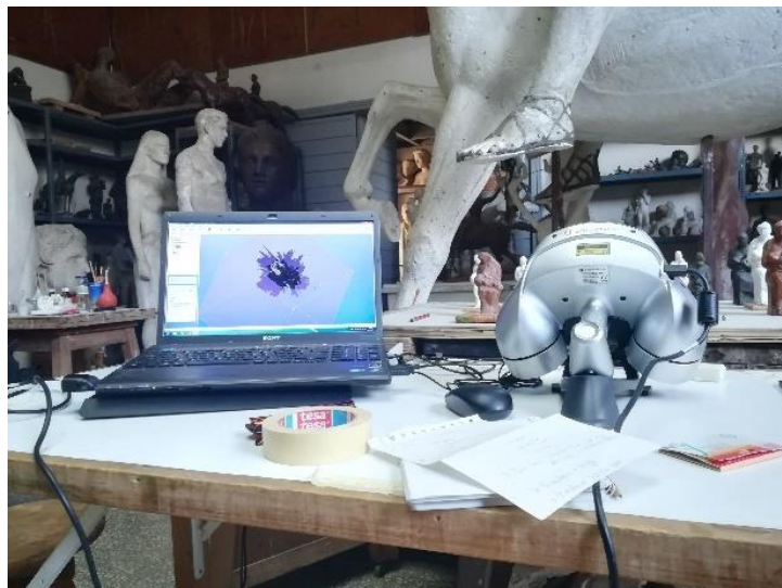
Εικ. 110: Ο απαιτούμενος εξοπλισμός για την τρισδιάστατη σάρωση.
