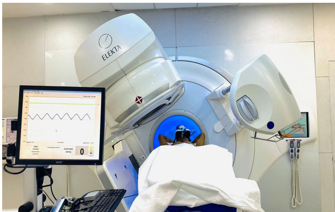
Εικόνα 14: Οθόνη ελέγχου ABC, σε μηχάνημα Elekta Versa. Στο αναπνευστικό διάγραμμα της οθόνης, φαίνεται η χαρακτηριστική πράσινη γραμμή/όριο.
