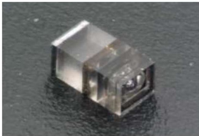
Εικόνα 3-2: Η μικρότερη κάμερα παγκοσμίως, διαστάσεων 1,16x0,58x0,58 mm
