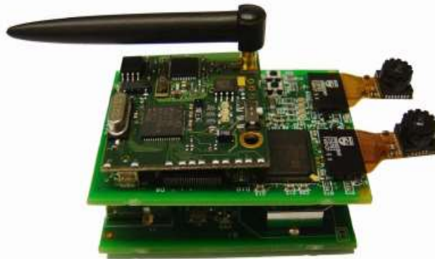
Εικόνα 6-8: Ασύρματο mote έξυπνης κάμερας με ενσωματωμένους αισθητήρες εικόνας VGA και σύστημα όρασης υψηλής απόδοσης [190]
