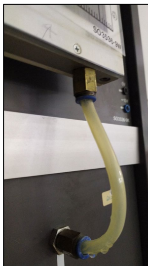
Εικόνα 3.3-17: Εντοπισμός του στοιχείου πρόκλησης του υδραυλικού κωλύματος Αρχαιακό υλικό
