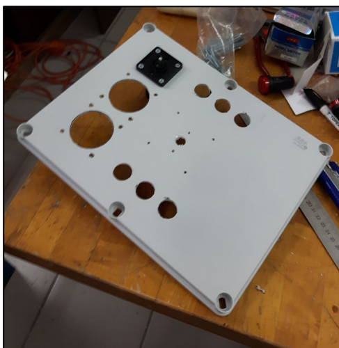
Εικόνα 3.3-22: Παράδειγμα διαμόρφωσης κυτίου εξοπλισμού Αρχαιακό υλικό
