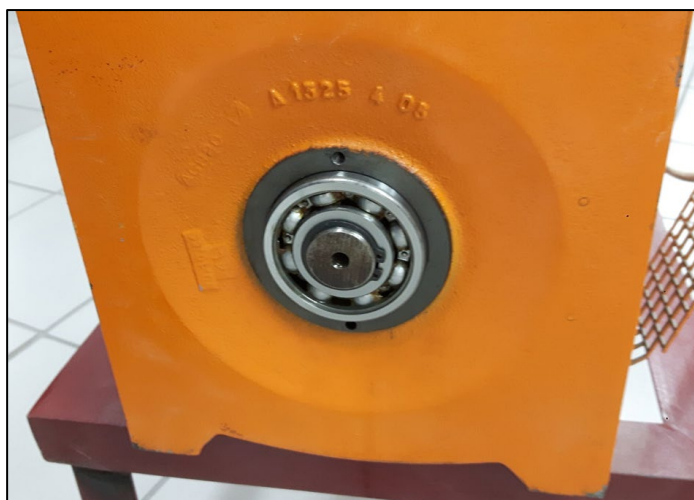
Εικόνα 3.3-10: Επιθεώρηση, καθαρισμός και λίπανση του εδράνου κύλισης (ρουλεμάν) της γεννήτριας Αρχαιακό υλικό
