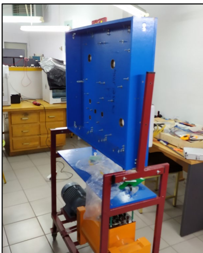
Εικόνα 3.3-33: Τοποθέτηση κυτίου καλωδίωσης και ενισχυτικών στοιχείων Αρχειακό υλικό
