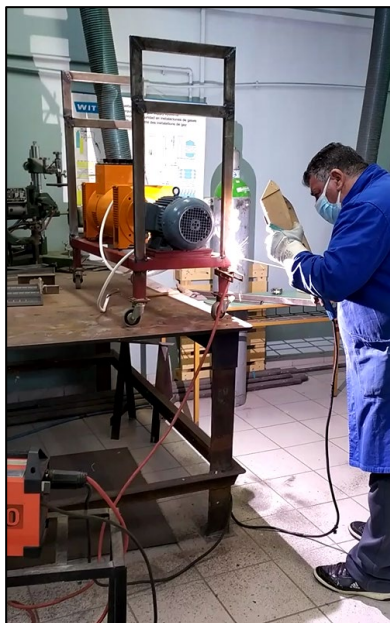
Εικόνα 3.3-30: Στιγμιότυπο της διαδικασίας συγκόλλησης του τμήματος που προστέθηκε στη βάση Αρχειακό υλικό
