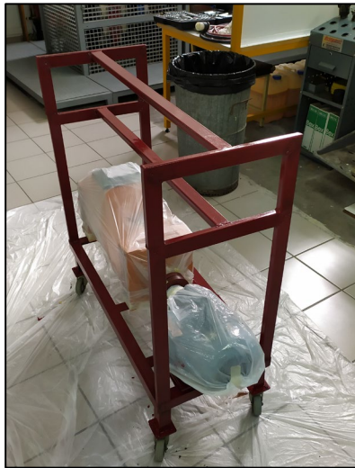
Εικόνα 3.3-31: Βαφή των μεταλλικών επιφανειών Αρχεϊακό υλικό
