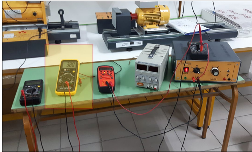
Εικόνα 3.3-14: Εξοπλισμός που χρησιμοποιήθηκε για τη διέγερση της γεννήτριας κατά την περίοδο δοκιμών Αρχειακό υλικό
