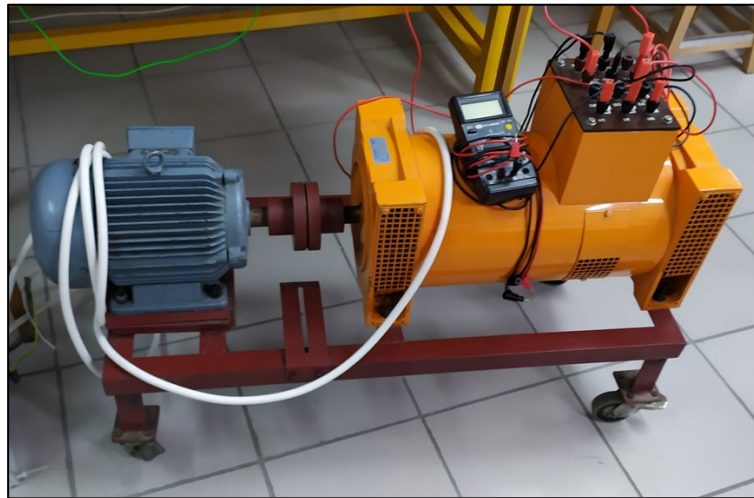
Εικόνα 3.2-10: Γενική άποψη της διάταξης ηλεκτρικού κινητήρα-γεννήτριας κατά την περίοδο δοκιμών Αρχειακό υλικό
