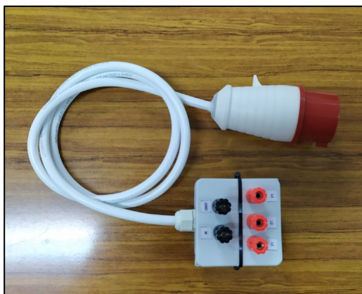
Εικόνα 3.3-41: Βιομηχανικός, τριφασικός ρευματολήπτης που καταλήγει σε μπόρνες Αρχειακό υλικό
