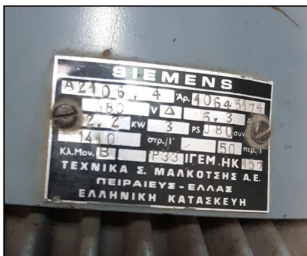
Εικόνα 3.3-1: Επιγραφή στοιχείων του κινητήρα Αρχειακό υλικό
