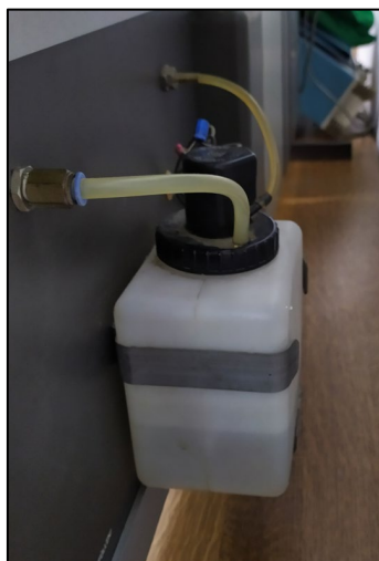
Εικόνα 3.3-19: Το δοχείο αποθήκευσης του υγρού της δεξαμενής και η αντλία Αρχειακό υλικό
