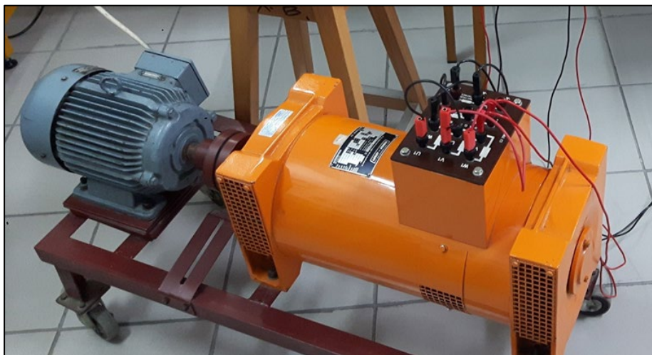
Εικόνα 3.3-13: Στιγμιότυπο της περιόδου δοκιμών της διάταξης κινητήρα-γεννήτριας Αρχειακό υλικό
