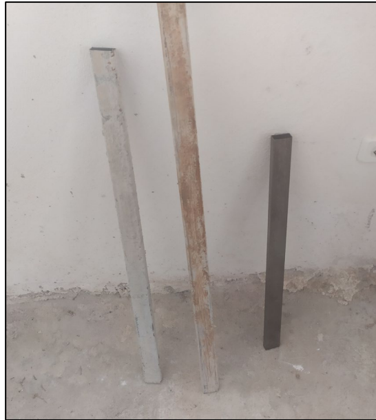
Εικόνα 3.3-28: Στάδια καθαρισμού και προστασίας των μεταλλικών δοκών Αρχειακό υλικό
