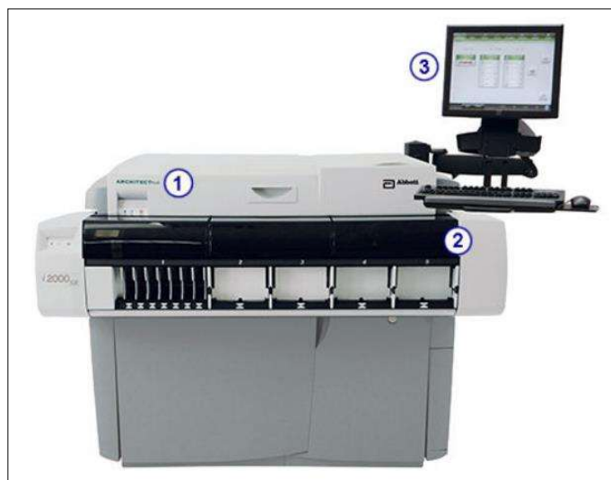
Εικόνα 26 Κύρια τμήματα Architect i2000SR Πηγή: Architect i Operation manual
