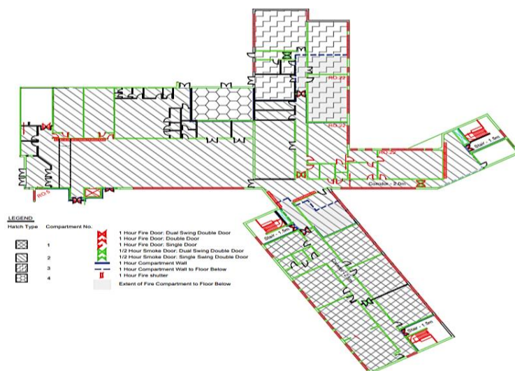
Εικόνα 11.4: Σχεδιασμός διαμέρισης πολυώροφης κατασκευής (Πηγή: Fu, 2021)
