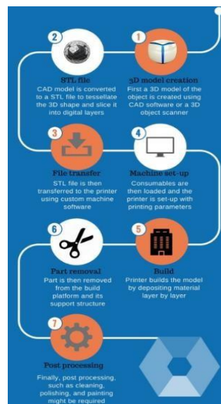
Εικόνα 3: Τα στάδια κατασκευής βήμα προς βήμα.
