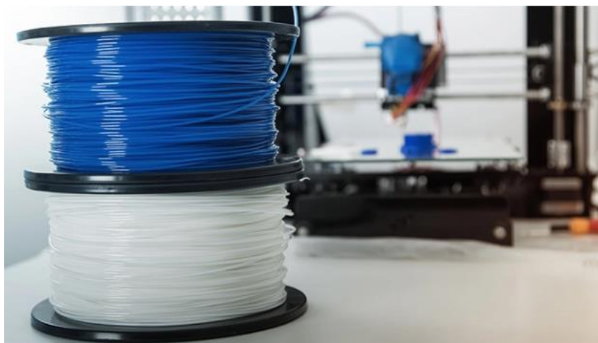
Εικόνα 24: Καρούλι με υλικό PLA για εκτύπωση. (Carlota, 2019)
