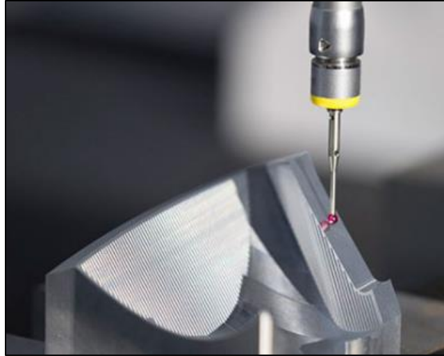
Εικόνα 3.1.1: 8 Ακίδα από σαρωτή με αισθητήρα επαφής
