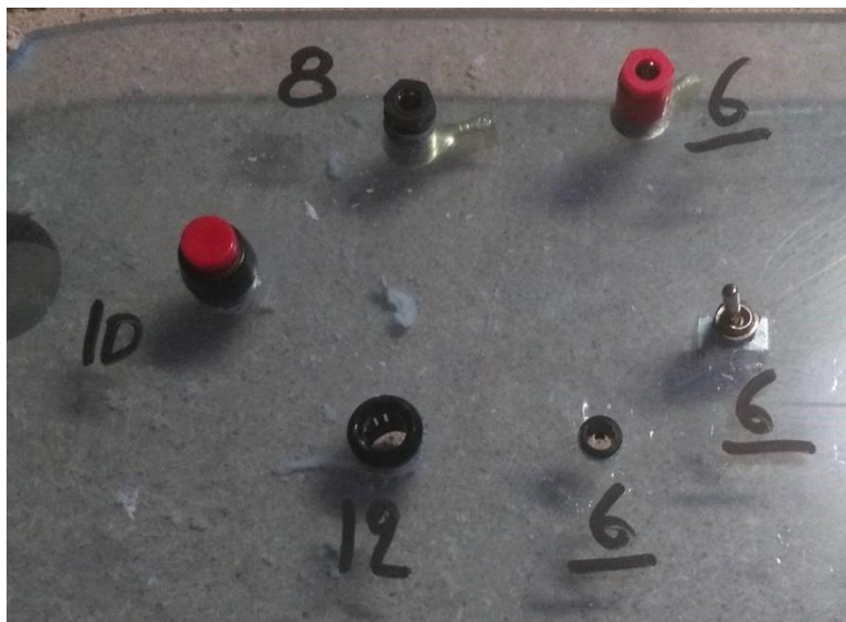
Εικόνα 62: Διάμετρος από χαρακτηριστικές διαστάσεις οπών που χρειάζεται να δημιουργηθούν στο plexiglass και τα αντικείμενα που θα τοποθετηθούν πάνω στην εκπαιδευτική μονάδα.
