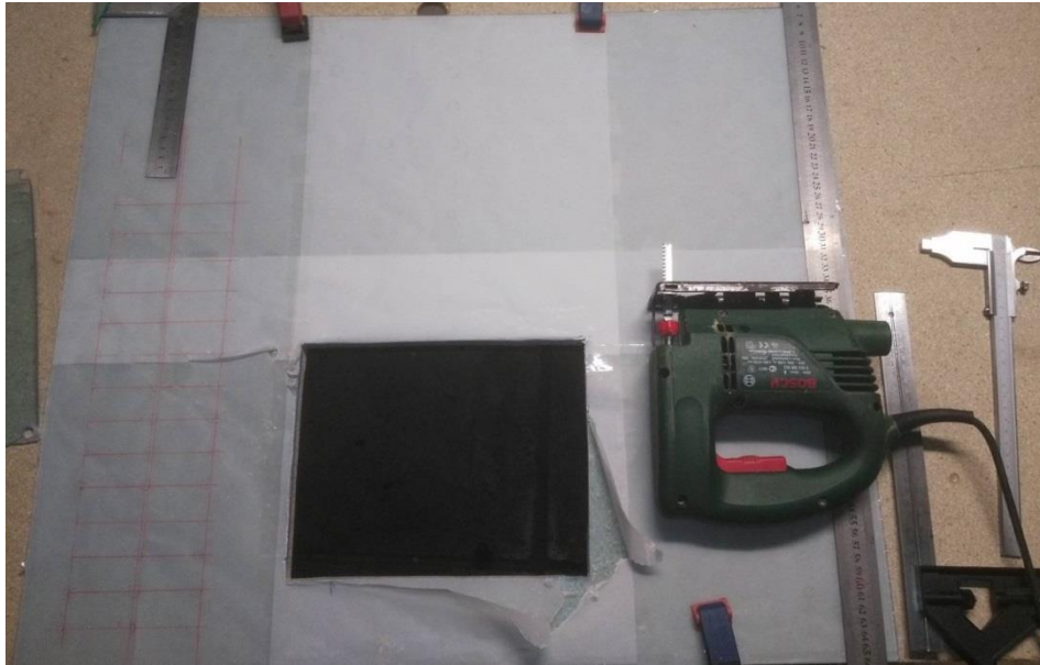
Εικόνα 63: Κοπή plexiglass με χρήση ηλεκτρικού πριονιού και τρυπανιού.
