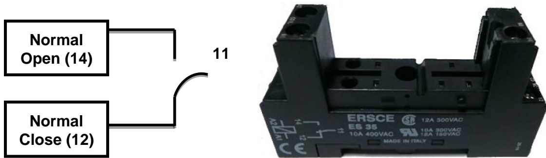
Εικόνα 73: Εσωτερική σύνδεση ηλεκτρονόμου.
