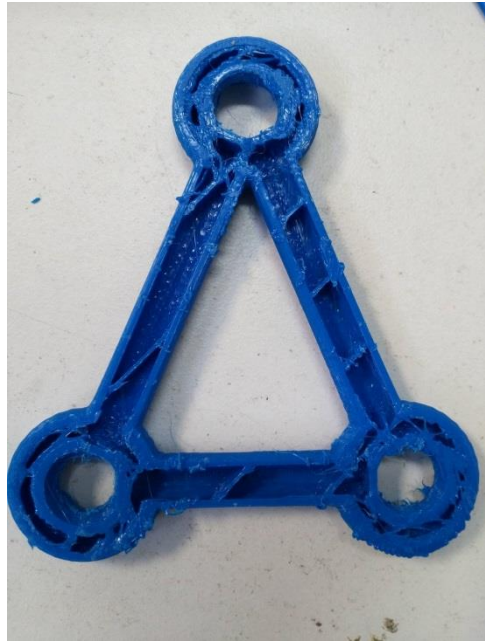
Εικόνα 86: Μέση τομή αντικειμένου. Η εκτύπωση διακόπηκε στο μισό χρόνο.
