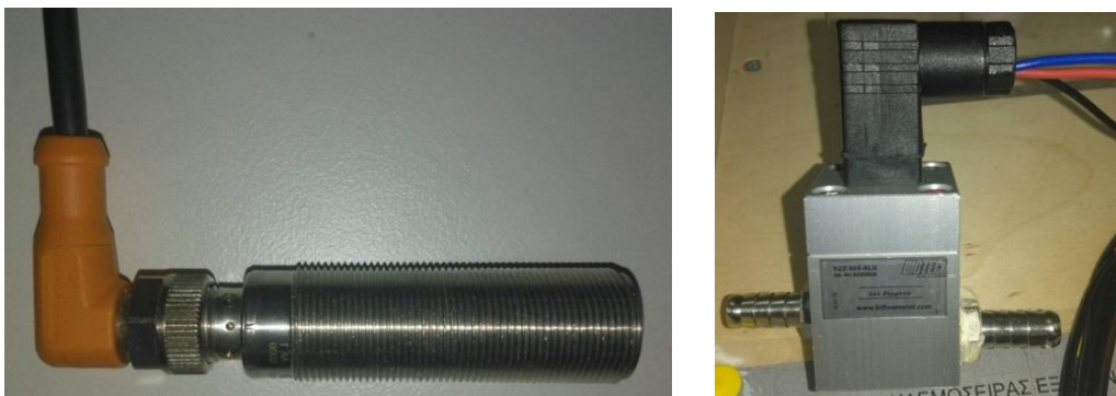
Εικόνα 96: Αισθητήρας μέτρησης στροφών (αριστερή εικόνα) και αισθητήρας ροής (δεξιά εικόνα).
