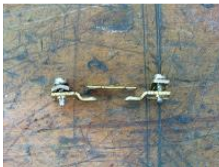
Εικόνα 93: Μια επαφή του ηλεκτρονόμου. Το μεσαίο είναι το κινητό μέρος της επαφής ( https://greekelectrician.blogspot.gr ).
