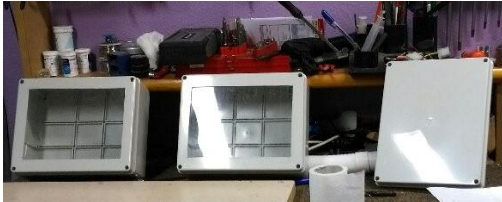
Εικόνα 65: Καπάκια ηλεκτρολογικών κουτιών (δεξιά είναι πριν την επεξεργασία και αριστερά μετά την επεξεργασία).
