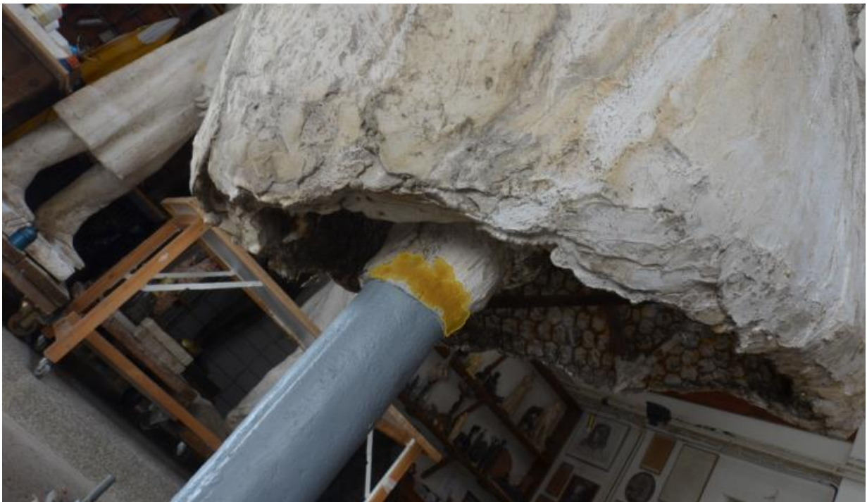
Εικόνα 59: Η χαρτογράφηση των μεταλλικών λεκέδων στο σημείο που η γύψος ενώνεται με τον μεταλλικό σκελετό του γλυπτού. (Η φωτογραφία είναι από το προσωπικό αρχείο)
