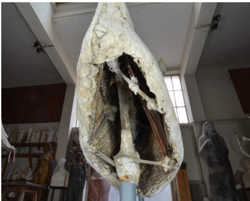
Εικόνα 66: Φωτογραφία από τον διαβρωμένο σκελετό του γλυπτού. (Η φωτογραφία είναι από το προσωπικό αρχείο)
