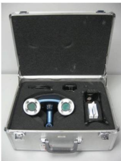
Εικόνα 82: Ο τρισδιάστατος οπτικός σαρωτής laser ZScanner 700cx. (εικόνα από το βιβλίο του σαρωτή, Self-Positioning Handheld 3D Scanner, Method Sheet: How to Connect and Store the Scanner in Its Cas)
