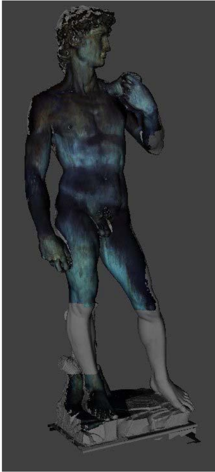
Εικόνα 26:Χαρτογράφηση των εικόνων UV στο αντίστοιχο τμήμα του ψηφιακού μοντέλου του αγάλματος. (εικόνα από το άρθρο "Using optically scanned 3D data in the restoration of Michelangelo's David")
