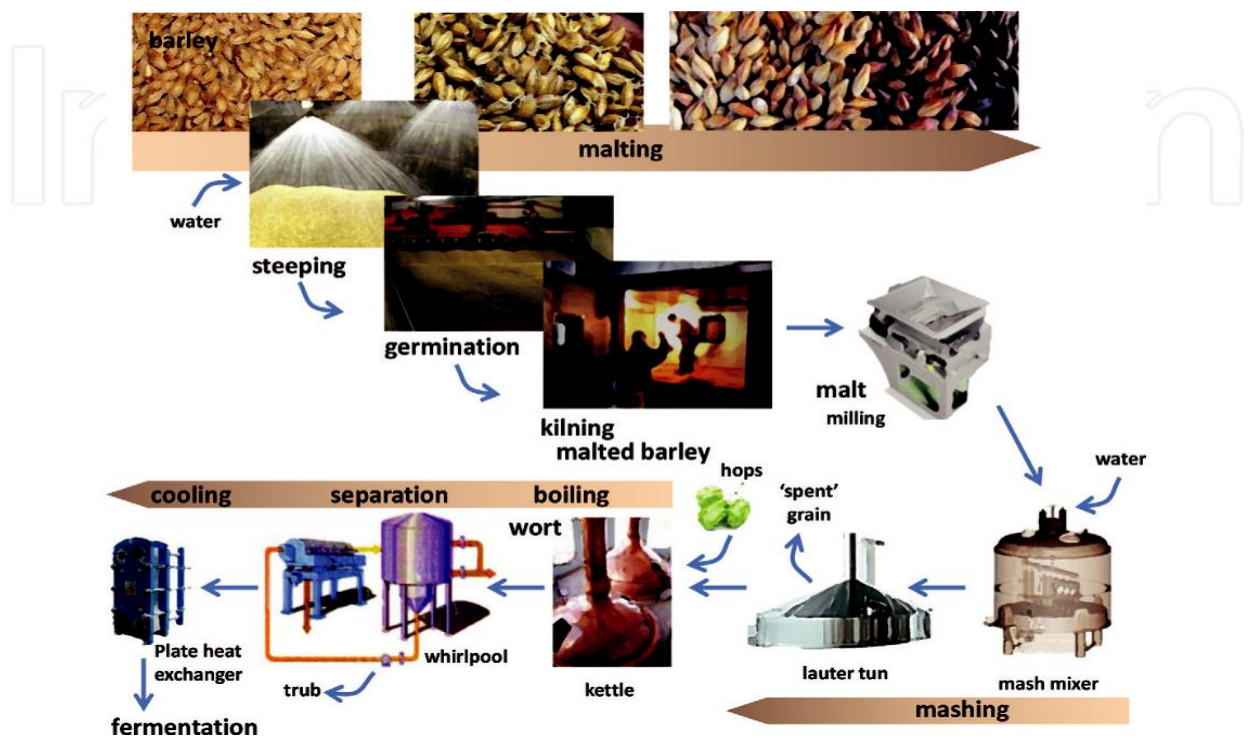
Εικόνα 1: Διαδικασία βύνης και παρασκευής. Πρώτα βήματα προετοιμασίας και προετοιμασίας ζυθογλεύκους. (Callejo, et al. , 2017).
