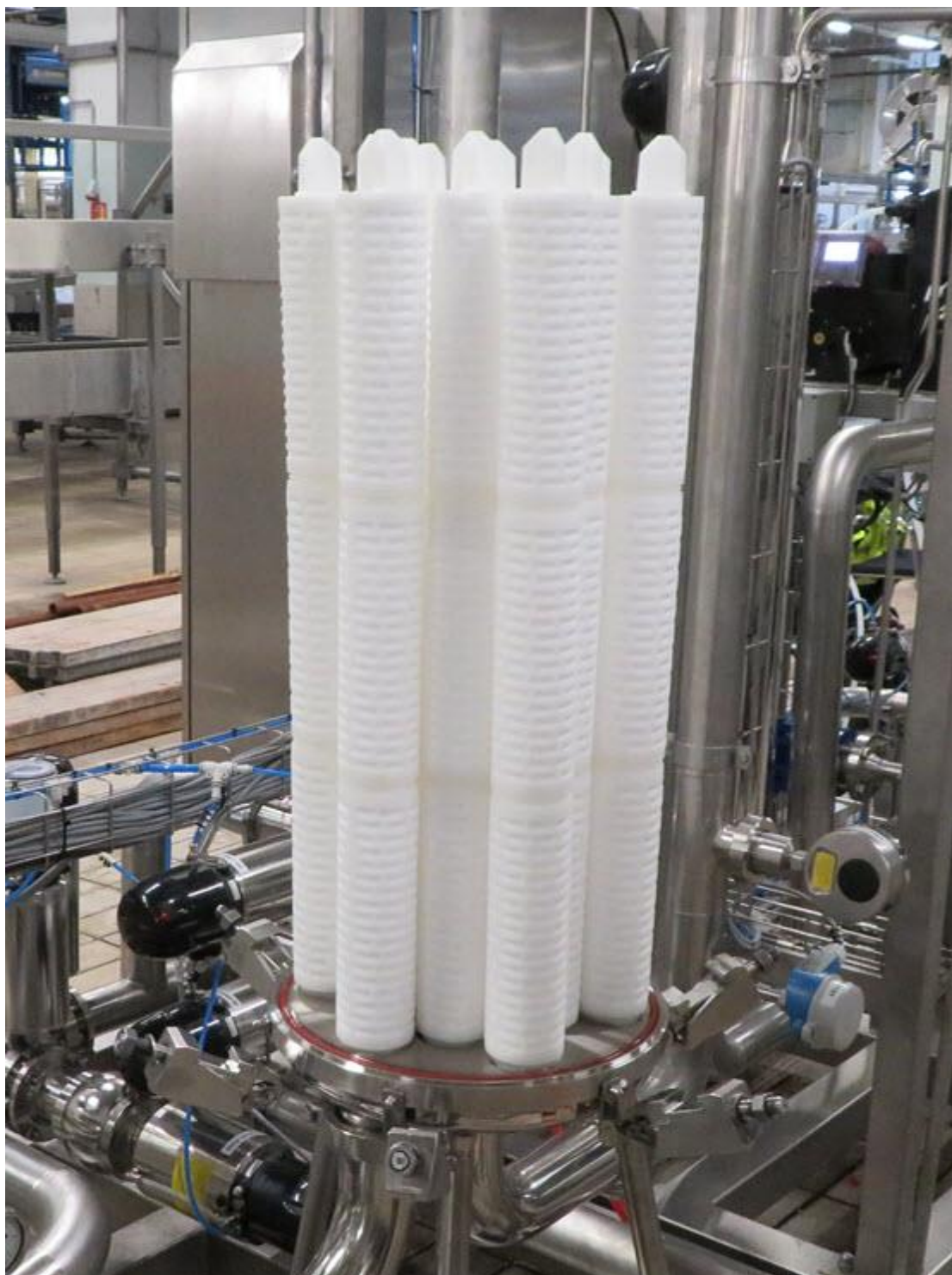
Εικόνα 10: Τα φίλτρα PREPOR NG του Parker Bioscience Filtration έχουν αναπτυχθεί ειδικά για την αφαίρεση ζυμομυκήτων και σωματιδίων, όπως βοηθητικά φίλτρα και συστατικά θολότητας. Το ανώτερο επίπεδο συγκράτησης διασφαλίζει ότι παρέχεται μια σταθερή ποιότητα της παρασκευής και παρέχει μεγαλύτερο επίπεδο προστασίας του φίλτρου μεμβράνης κατά τη διάρκεια της ψυχρής σταθεροποίησης, Parker BEVPOR BR, 2021).
