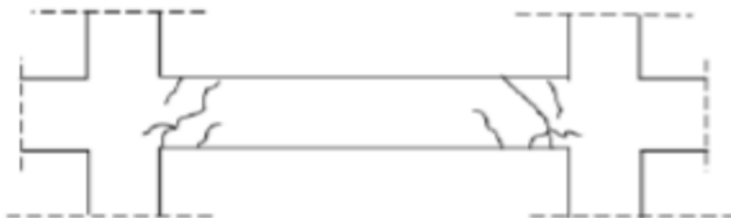
Σχήμα 2. 11: Διατμητική αστοχία δοκού 11
