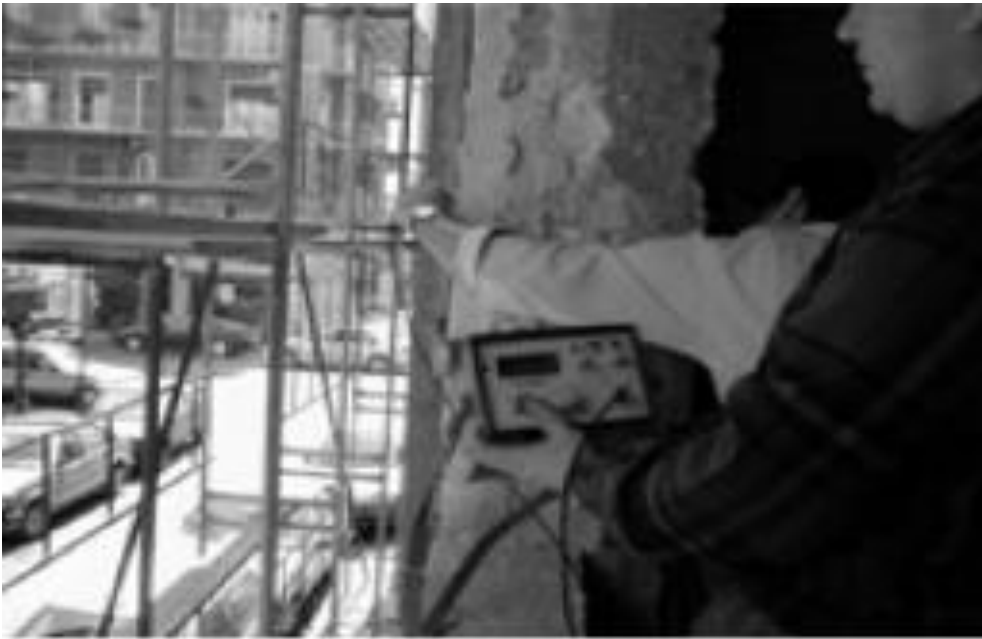
Σχήμα 5. 2: Υπέρηχος σε σκυροδέμα (Πηγή: Σπυράκος, 2004)
