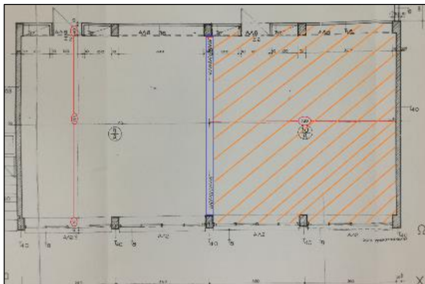
Εικόνα 20: Λεπτομέρεια κάτοψης ισογείου. Με πορτοκαλί σημειώνεται η αίθουσα του ολοήμερου (ΟΛ1). Με κόκκινο οι διαστάσεις στο σχέδιο, με μπλε ο μόνιμος τοίχος που αντικατέστησε τις πόρτες διαχωρισμού των αιθουσών. Πηγή: Αρχείο 27ου Δ.Σ.
