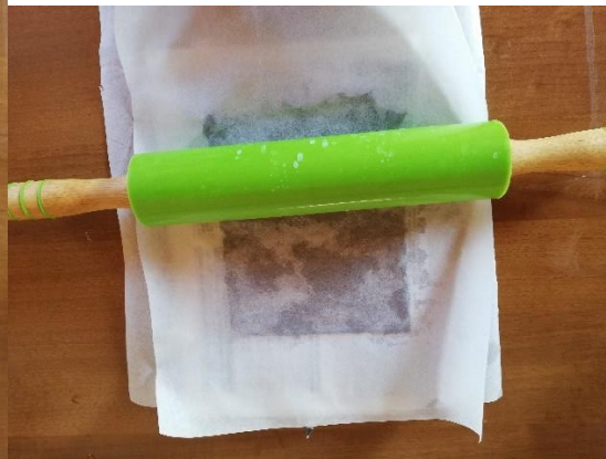
Εικόνα 4.6 Απομάκρυνση περίσσειας νερού με πλάστη
