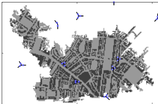
Εικόνα 7. Απεικόνιση της διάταξης δικτύου. Οι μακρο-κυψέλες επισημαίνονται με μπλε κύκλους και με γραμμή προς την κατεύθυνση του κύριου λοβού της κεραιάς (a.k.a. broadside). Το ανοιχτό γκρι χρώμα αντιστοιχεί σε εξωτερικούς χώρους ενώ το σκούρο γκρι εσωτερικούς.
