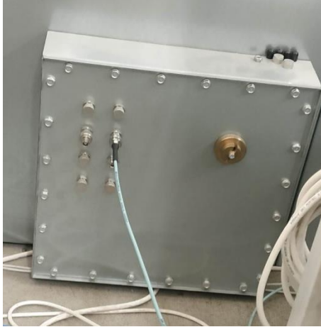
Εικόνα 2.19 Σύνδεση ενισχυτή με την (α) εξωτερική και την (β) εσωτερική πλευρά του πάνελ εισόδων/εξόδων.
