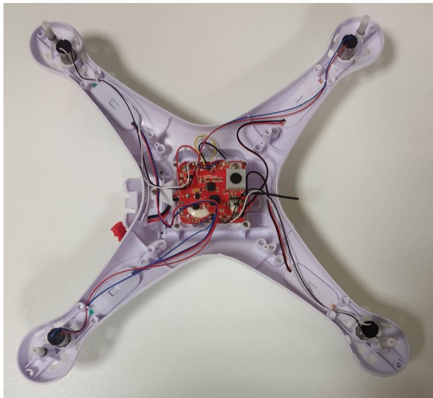
Εικόνα 2.31 Το Syma X5HW έχοντας αφαιρέσει το καπάκι.
