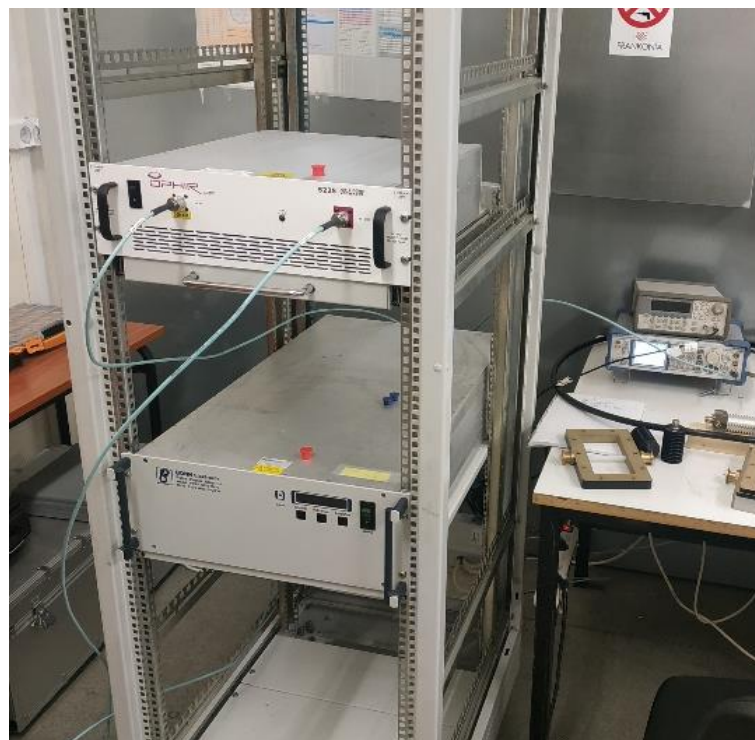
Εικόνα 2.18 Σύνδεση της γεννήτριας με τον ενισχυτή.
