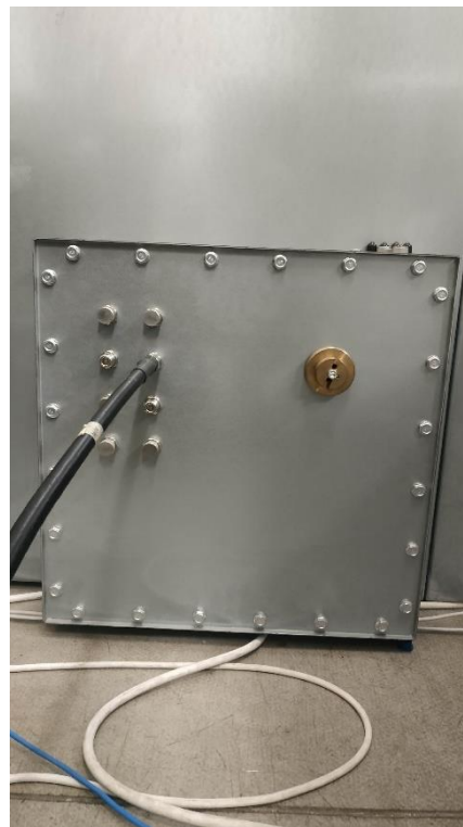
Εικόνα 2.3 Πάνελ διασύνδεσης καλωδίων του θαλάμου (εξωτερική άποψη).
