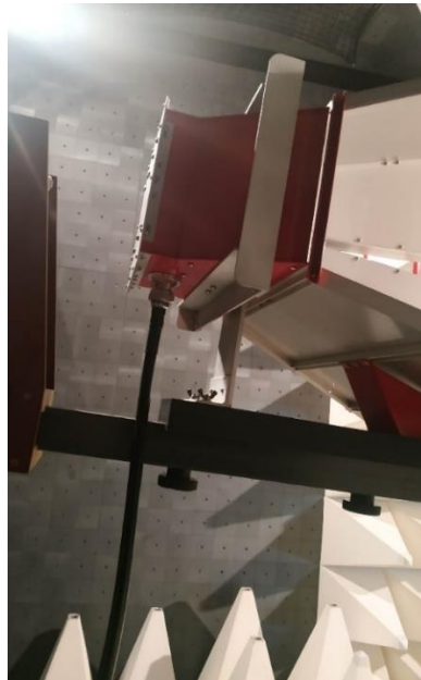
Εικόνα 2.20 Η σύνδεση με την κεραία με καλώδιο 7-16.
