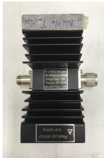
Εικόνα 2.22 Ο εξασθενητής 30 dB ο οποίος χρησιμοποιήθηκε για την μέτρηση του ενισχυτή.
