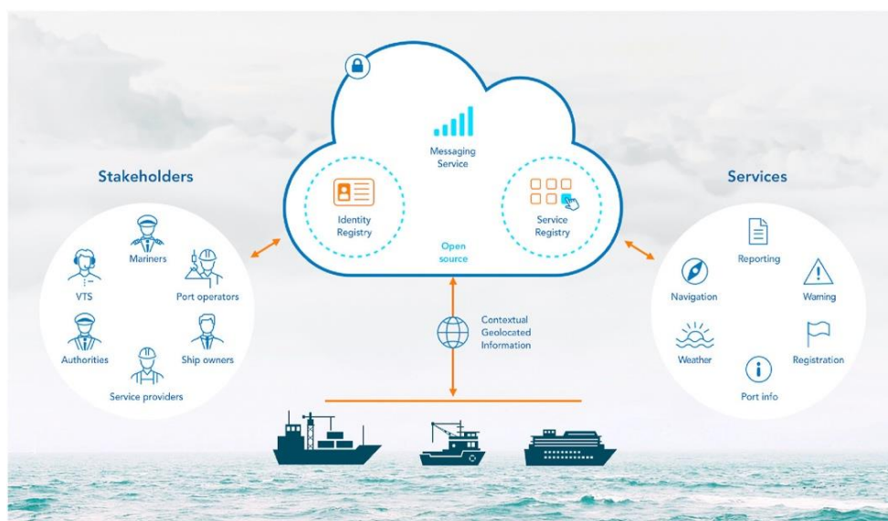
Εικόνα 6 Διάγραμμα της λειτουργίας της πλατφόρμας MCP (Zhang et al, 2021).
