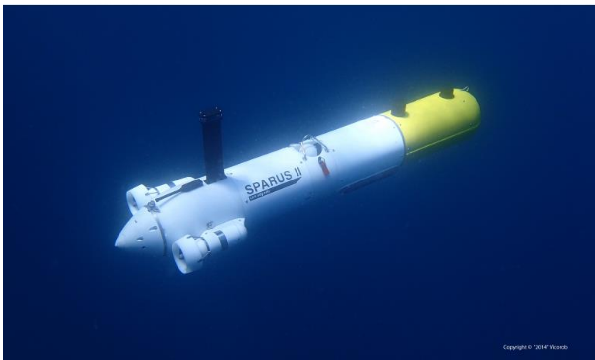
Εικόνα 1 Φωτογραφία του Sparus II, ένα αυτόνομο υποβρύχιο πλοίο AUV (Cirs.edu.org, 2014)
